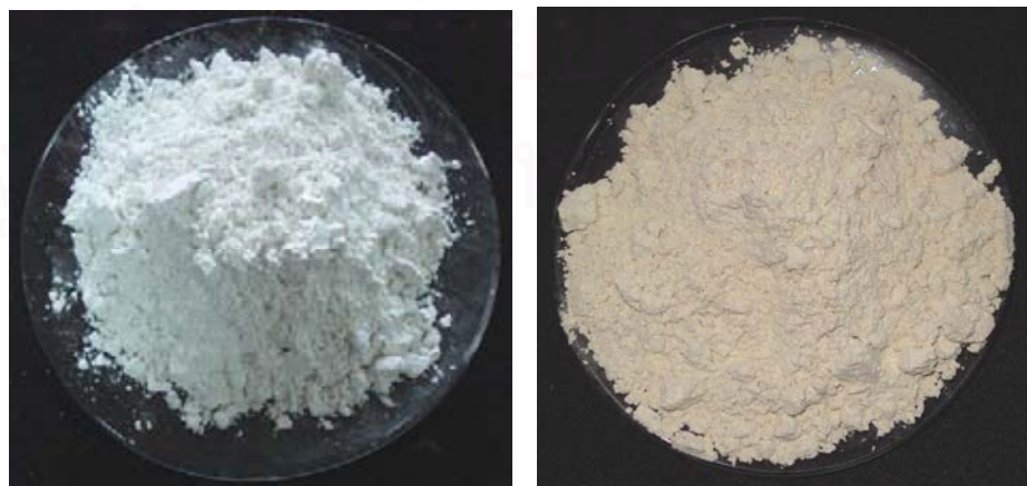
รูปที่ 4.5 ดินขาวธรรมชาติก่อนและหลังการปรับปรุงคุณภาพด้วยความร้อน
