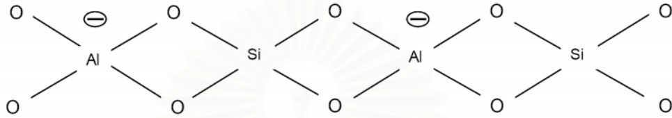
รูปที่ 2.19 ประจุลบที่เกิดจากการแทนที่ด้วย (\text{AlO}_2)^- ในโครงสร้างของซีโอไลต์ (เลิศ, 2545)
