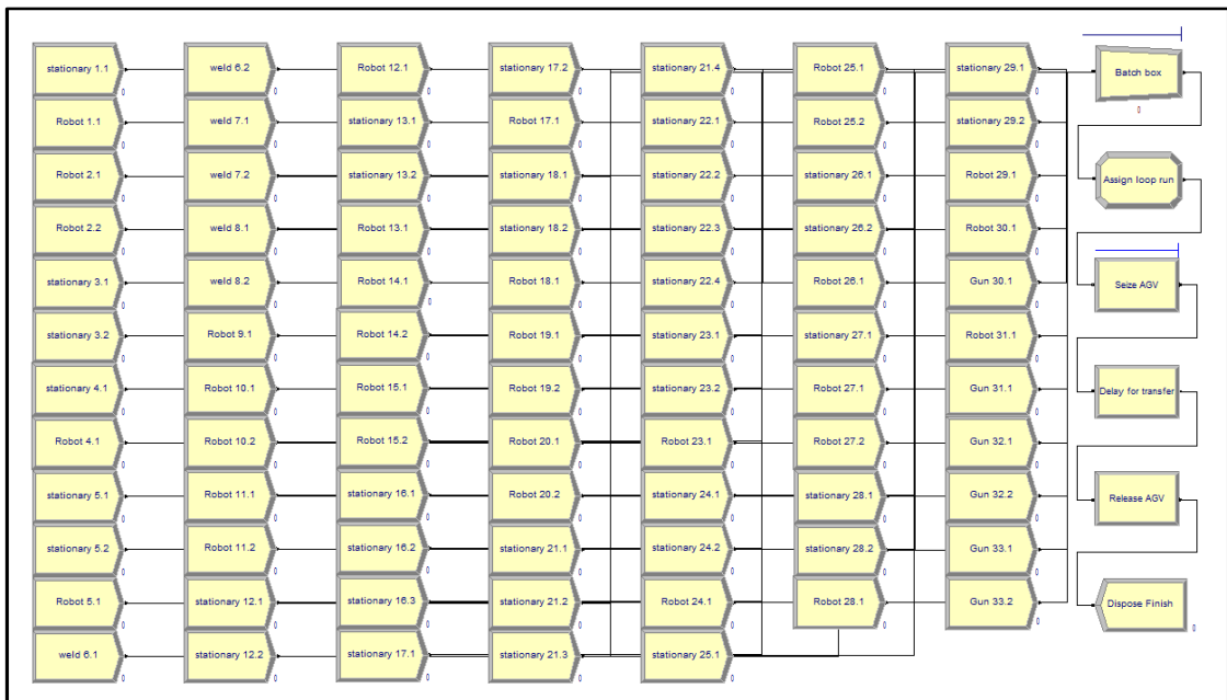
ภาพที่ 4-41 ตัวแบบจำลองของแนวทางการขนส่งชิ้นส่วนด้วยพาหนะขนส่งชิ้นส่วนอัตโนมัติ
