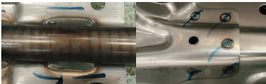
ภาพที่ 1-4 ลักษณะการประกอบแบบแนวเชื่อมและการประกอบแบบจุดตามลำดับ
