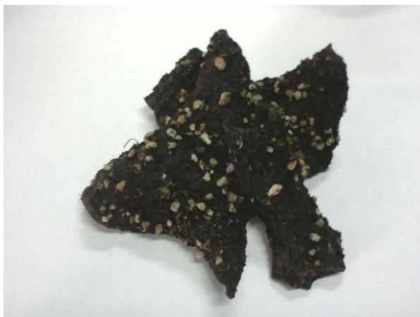
ภาพที่ 3.2 กากตะกอนจากการบำบัดน้ำเสีย
