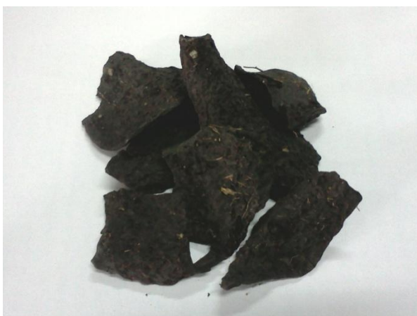
ภาพที่ 3.3 กากตะกอนจากการบำบัดน้ำเสียที่ผ่านการทำความสะอาดแล้ว
