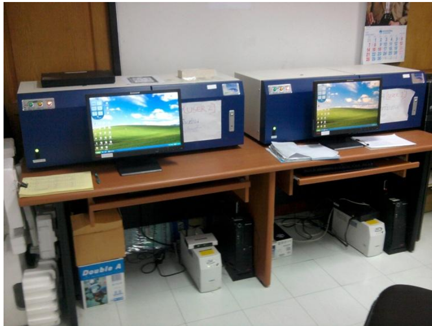
ภาพที่ 2.7 เครื่องมือในการอ่านค่าปริมาณรังสีที่วัดได้จากแผ่นวัดรังสีไอเอสแอล
