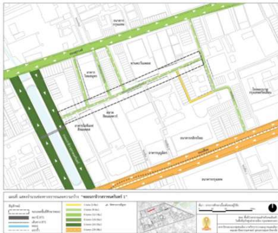
แผนที่ 4.42 แสดงลักษณะการสัญจร ขนาดช่องจราจรภายในซอยนราธิวาสราชนครินทร์ 1
