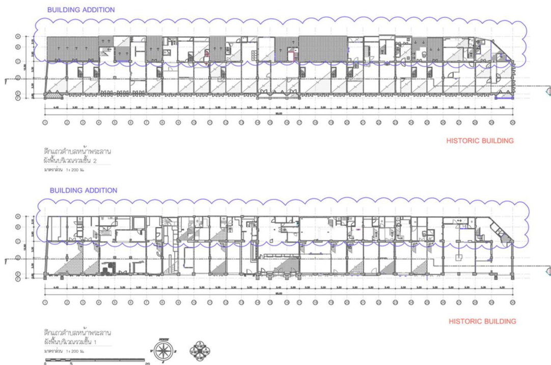
ภาพที่ 4.14 แสดงแปลนชั้นล่างและชั้นบนก่อนปรับปรุง อาคารหน้าพระลาน ที่มา : สำนักงานทรัพย์สินส่วนพระมหากษัตริย์
