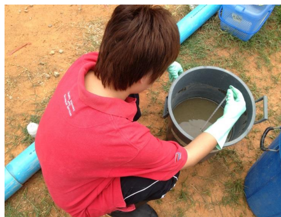
ภาพที่ ก-1.6 การวัดพีเอชและอุณหภูมิน้ำเสีย
