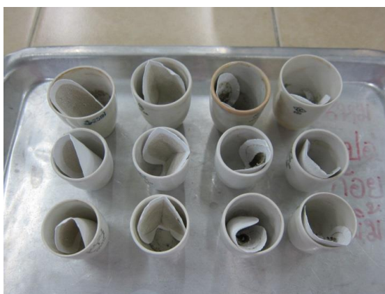
ภาพที่ ก-1.12 การวิเคราะห์ของแข็งทั้งหมด ของแข็งแขวนลอย และของแข็งแขวนลอยระเหย
