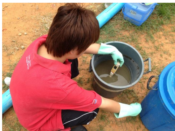
ภาพที่ ก-1.6 การวัดพีเอชและอุณหภูมิน้ำเสีย
