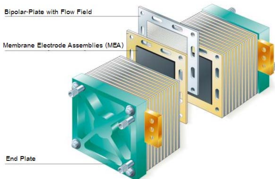
ภาพที่ 2-3 การประกอบเซลล์เชื้อเพลิงเป็นเซลล์แถว [31]
