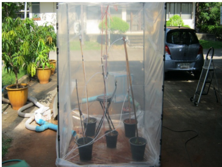
ภาพที่ 4 การทดสอบความสม่ำเสมอของแก๊สโอโซนทั้งหมด 5 จุด 3 ระดับความสูง คือ 0.5 เมตร 1.0 เมตร และ 1.5 เมตร
