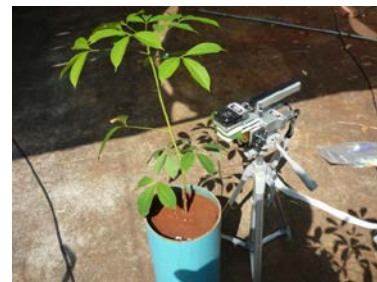
ภาพที่ 5 วิธีการให้อากาศและอากาศที่เติมแก๊สโอโซนกับต้นยางพารา และการเก็บอุณหภูมิ ความชื้นสัมพัทธ์ ความเข้มข้นของแก๊สโอโซน และความเข้มแสง
