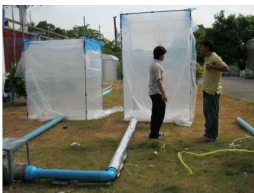
ภาพที่ 1 Chamber ที่ใช้ในการทดลองมีความสูง 2.0 เมตร และ 2.5 เมตร ต่อกับท่อส่งอากาศจาก cooling pad box
