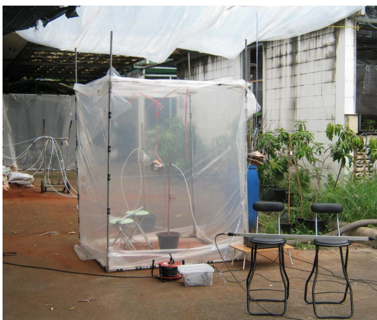
ภาพที่ 3 การศึกษาผลของความยาวสายสู่มอากาศต่อการวัดความเข้มข้นของแก๊สไอโซนภายใน chamber
