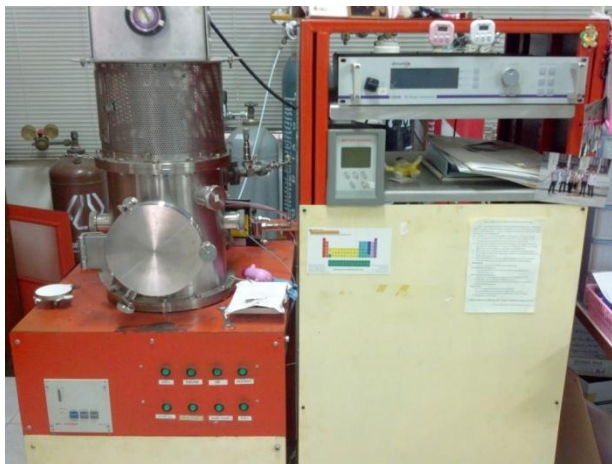
ภาพที่ 3.1 เครื่องอาร์-เอฟ พลาสมา (RF plasma) ที่ใช้ในการตัดแปรรูปร่างของเซลลูโลสเมมเบรน
