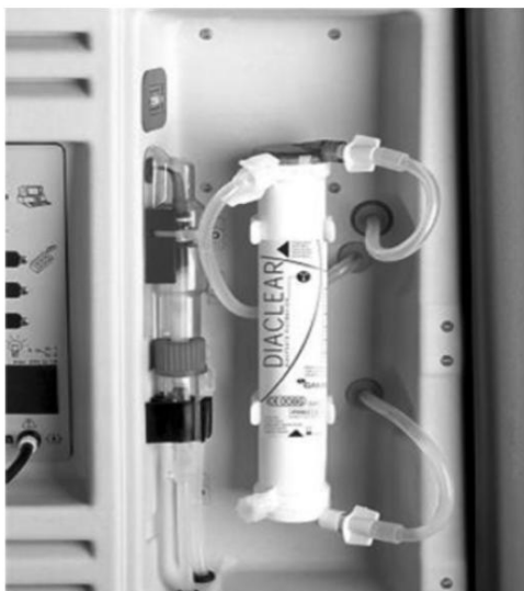
ภาพที่ 2.16 เครื่องกรอง (filter) ในเครื่องฟอกเลือดในกระบวนการไตเทียมโดยดำนในบรรจุ เมมเบรนที่ใช้ในกระบวนการไตเทียม
