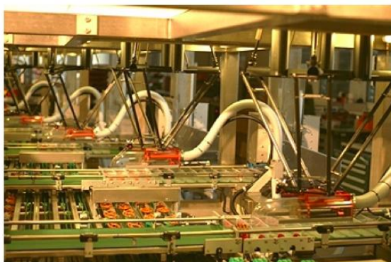
รูปที่ 2.11 หุ่นยนต์เคลตต้าของบริษัท ดีมอแรก [13]
