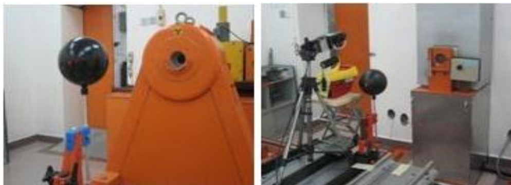
ก) ชุดต้นกำเนิดรังสีแกมมา
