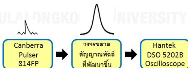
รูปที่ 4.6 แผนภาพการจัดอุปกรณ์ทดสอบสมรรถนะของวงจรขยายสัญญาณพัลส์
