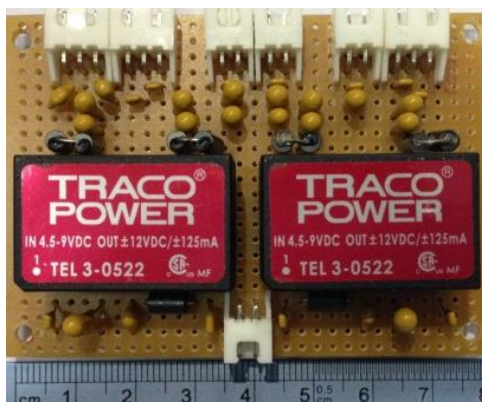
รูปที่ 3.3 วงจรแหล่งจ่ายไฟฟ้าสำหรับเครื่องวัดปริมาณรังสีแกมมาที่พัฒนาขึ้น
