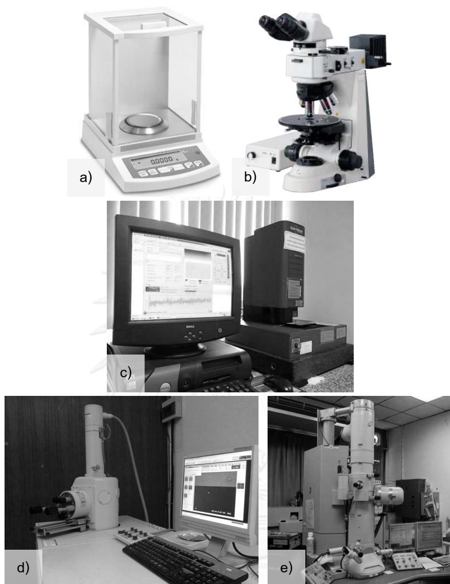
รูปที่ 3.3 เครื่องมือพิสูจน์เอกลักษณ์ชนิดต่างๆที่ใช้ได้แก่ a) เครื่องชั่งน้ำหนัก, b) กล้องจุลทรรศน์ชนิดใช้แสง, c) เครื่องวัดความหยาบผิว, d) กล้องจุลทรรศน์อิเล็กตรอนแบบส่องกราด และ e) กล้องจุลทรรศน์อิเล็กตรอนแบบส่องผ่าน
