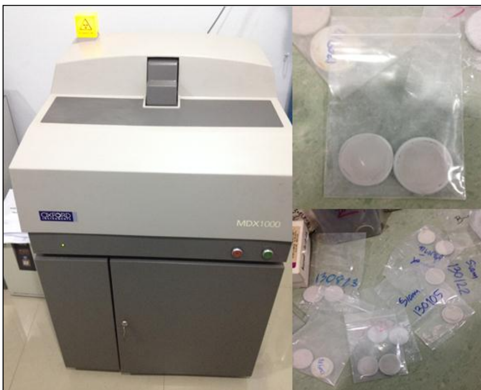
รูป ข. 1 เครื่องเอกซ์ เรย์ ฟลูออเรสเซนซ์สเปกโทรโกปี รุ่น MDX1000 (Oxford Instruments Analytical, 1997) และตัวอย่างแร่
