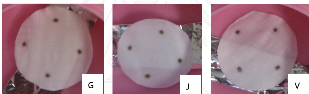
ภาพที่ ก.9 ตัวอย่างกระดาษกรองที่ใช้เก็บตัวอย่าง PM_{10}
