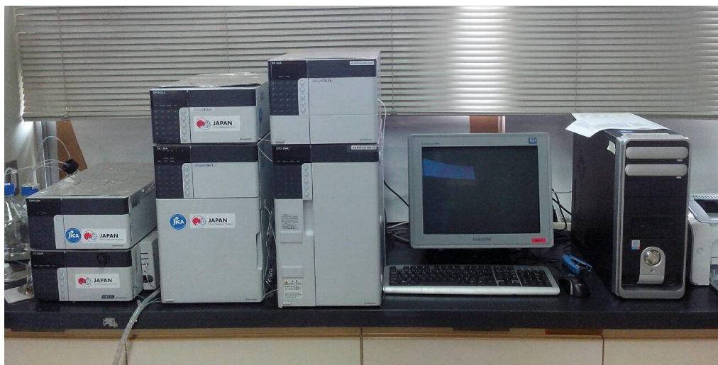
ภาพที่ ก.7 เครื่อง High Performance Liquid Chromatography (HPLC) detector คือ Fluorescence detector และ UV detector
