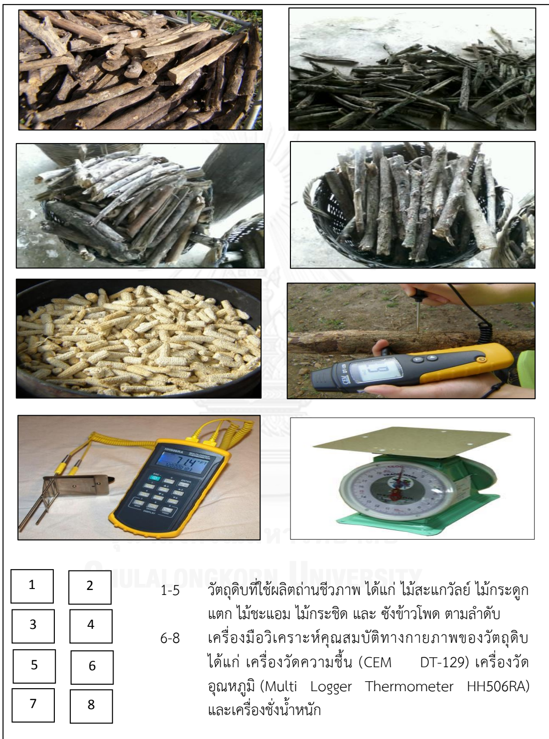
รูปที่ ผ. 3 วัสดุดิบที่ใช้ในการผลิตถ่านชีวภาพและเครื่องมือที่ใช้วิเคราะห์คุณสมบัติทางกายภาพของวัสดุดิบก่อนผลิตถ่านชีวภาพ
