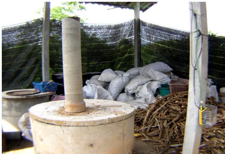
รูปที่ 3.1 เตาผลิตถ่านชีวภาพควบคุมอุณหภูมิในกระบวนการเปลี่ยนสภาพด้วยความร้อนแบบช้า (Controlled Temperature Biochar Retort For Slow Pyrolysis Process)
