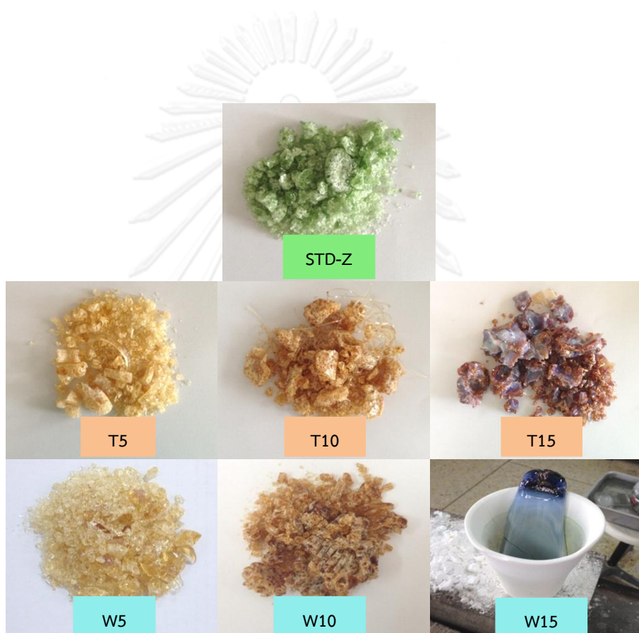
รูปที่ 6.1 ลักษณะของพริตที่ได้หลังอบให้แห้งที่อุณหภูมิ 110 องศาเซลเซียส
