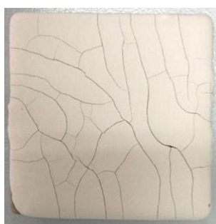
รูปที่ 5.7 ลักษณะการแตกร้าวของเคลือบสูตร B* C* และ D* เมื่อแห้งแล้ว
