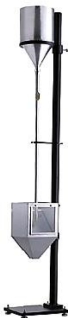
รูปที่ 2.7 เครื่องทดสอบความทนทานต่อการขีดสี ตามมาตรฐาน ASTM D 968-93 [21]
