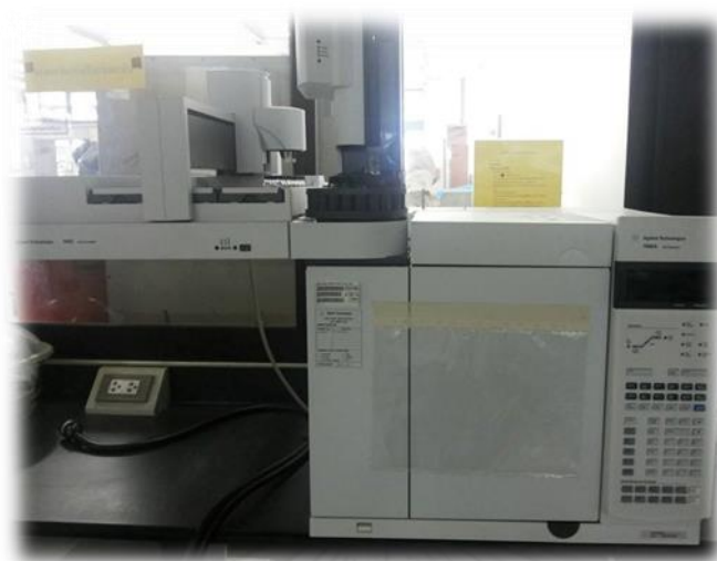
รูปที่ 3.1 เครื่องแก๊สโครมาโทกราฟ (Gas chromatograph) ของบริษัท Agilent technology รุ่น 7890A
