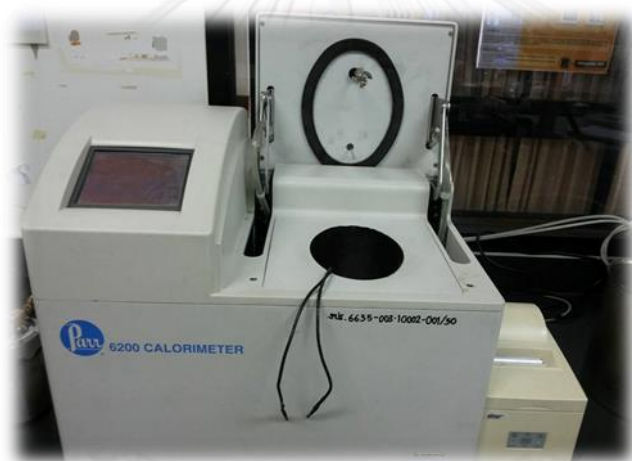
รูปที่ 3.4 เครื่องวัดค่าความร้อน (Heating value)
