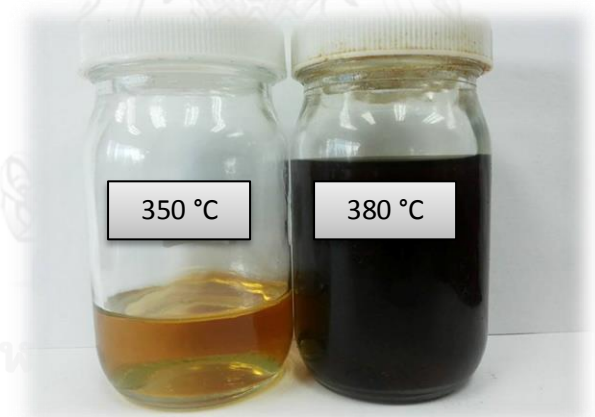
รูปที่ ซ.1 ภาพถ่ายเชื้อเพลิงชีวภาพที่ผลิตในเอทิลแอสีเททภาวะเหนือวิกฤตที่อุณหภูมิต่างๆ อัตราส่วนโดยโมลของเอทิลแอสีเทตต่อน้ำมันปาล์ม 30:1 และอะลูมินาบอลขนาด 6 มิลลิเมตร
