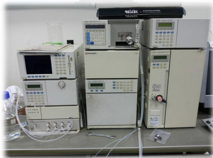
รูปที่ 3.3 เครื่องโครมาโทกราฟของเหลวสมรรถนะสูง (High Performance Liquid Chromatograph : HPLC) จากบริษัท Shimadzu รุ่น LC-10 ADvp
