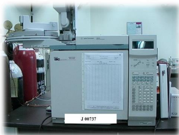
รูปที่ 3.2 เครื่องแก๊สโครมาโทกราฟจำลองลักษณะการกลั่น
