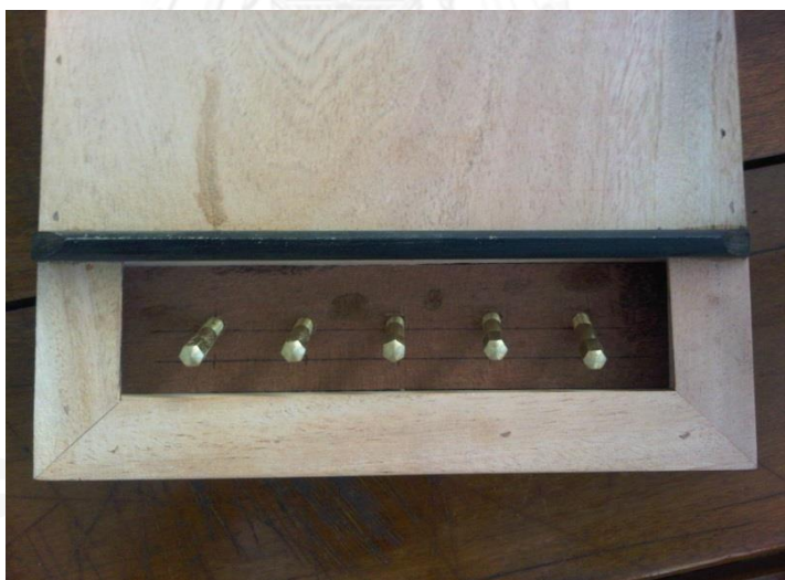
ภาพที่ 29 ตำแหน่งหลักตั้งเสียงเครื่องดัด ในการออกแบบครั้งที่ 6
