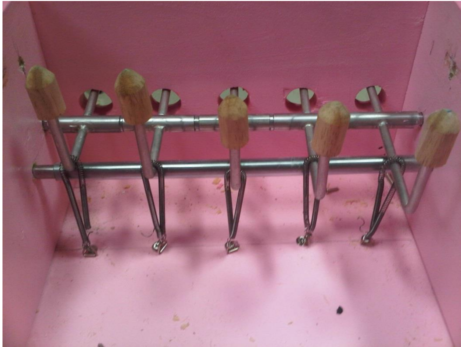
ภาพที่ 48 กลไกการทำงานของกระต๋องเคาะลูกระนาด ในการออกแบบครั้งที่ 6
