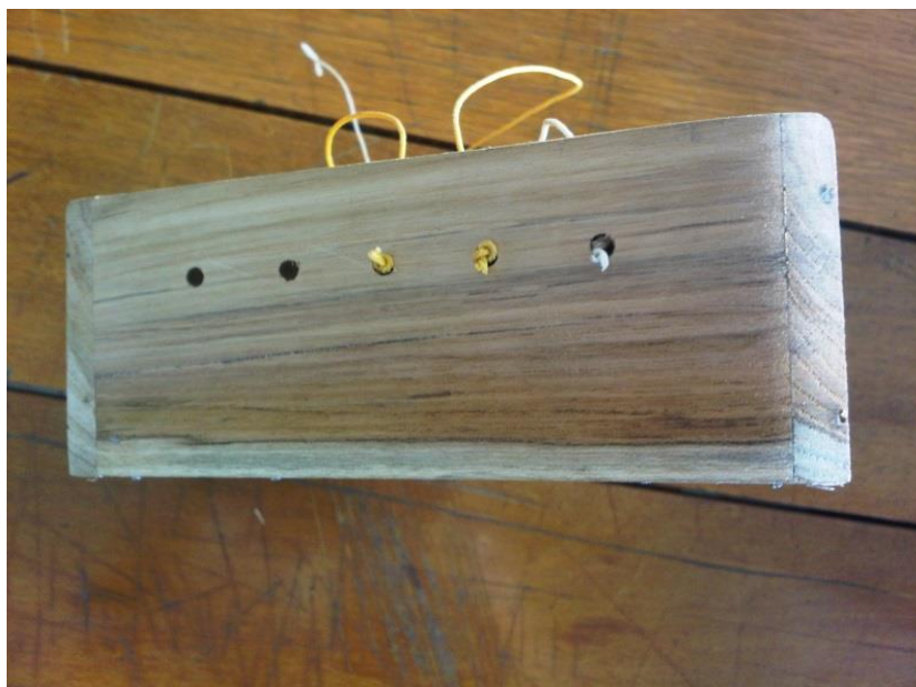
ภาพที่ 34 ฐานใส่สายสำหรับสี่ ในการออกแบบครั้งที่ 6
