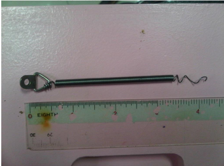
ภาพที่ 49 สปริงสำหรับถ่วงการยืดหยุ่นของกระต๋อง ในการออกแบบครั้งที่ 6
