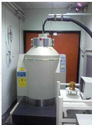
รูปที่ 3.1 เครื่องฉายรังสีแกมมา รุ่น Gamma cell 220excel
