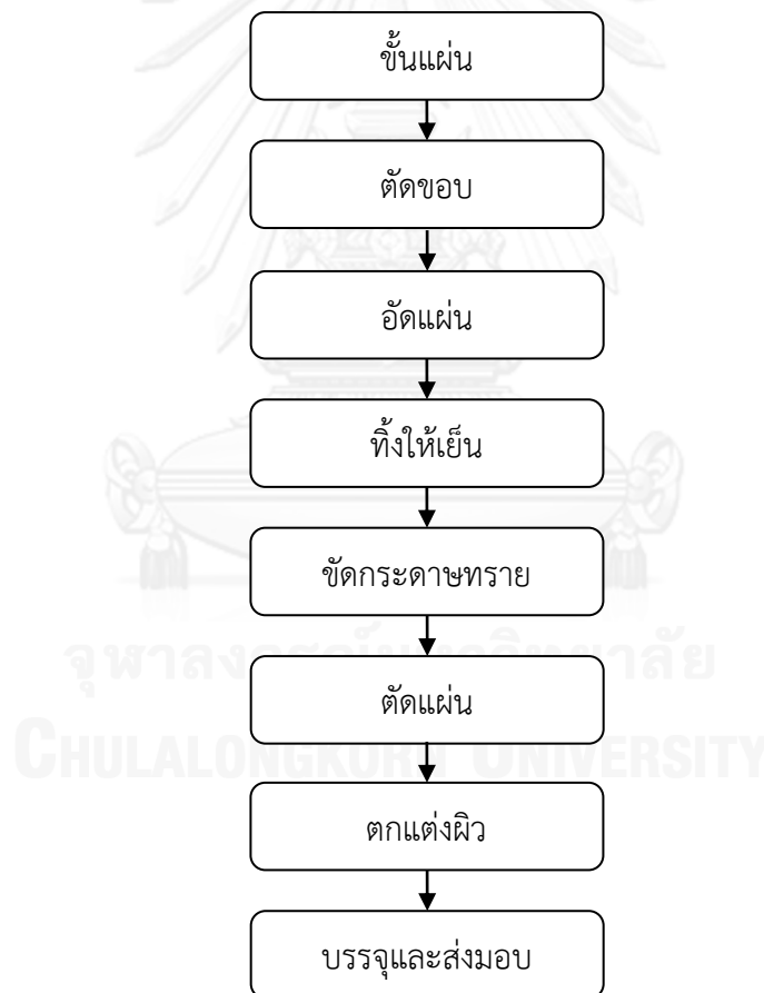
ภาพที่ 2.19 ขั้นตอนการผลิตชิ้นไม้อัด
