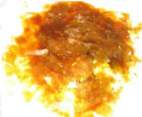
ภาพที่ 2.30 เซลแล็กที่ได้จากการผลิตด้วยเครื่องจักร (Machine-made) (ที่มา : http://www.bskoshellac.com/machine-made-shellac.htm )
