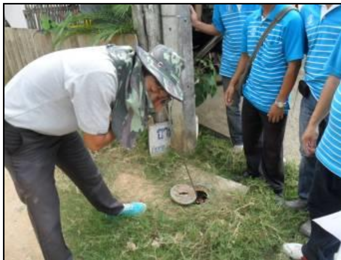
รูปที่ 2.14 การใช้เครื่องมือ Listening stick ในการฟังเสียงตามท่อน้ำประปาเพื่อตรวจสอบการรั่วไหล
