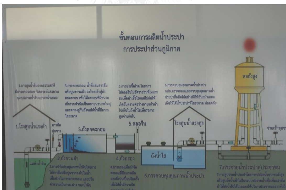
รูปที่ 2.5 กระบวนการผลิตน้ำประปาจากน้ำผิวดิน
