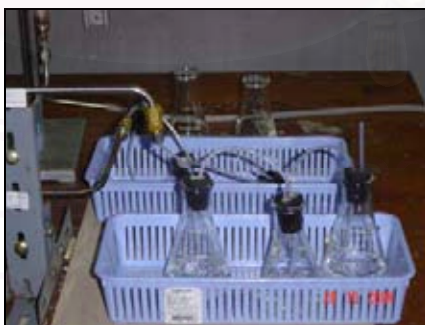
รูปที่ 3.4 อุปกรณ์ชักตัวอย่างแก๊สซัลเฟอร์ไดออกไซด์
