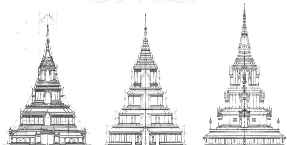
ภาพที่ 4.45 พัฒนาการของแบบรายละเอียดอาคารเครื่องยอดจากซ้ายไปขวา ด้านขวาสุดเป็นแบบที่ทำการสร้าง (ที่มาภาพ: ผศ. พงศกร ยิ้มสวัสดิ์)
