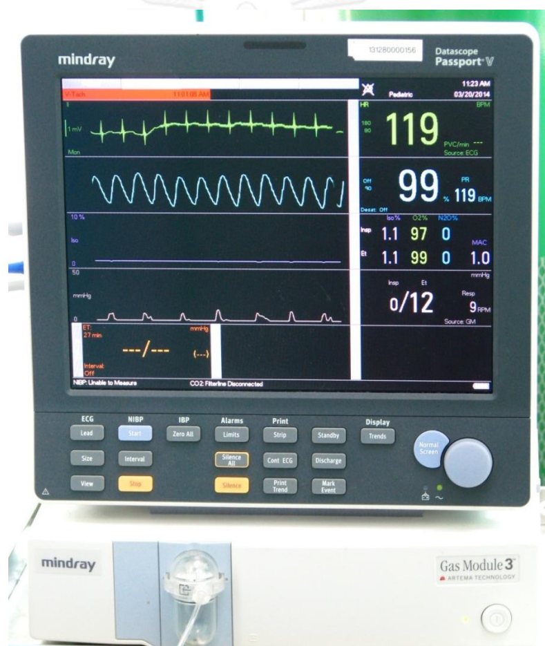
รูปที่ 14 เครื่องติดตามสัญญาณชีพ (Datascope PASSPORT® V) (บน) และ เครื่องวัดความเข้มข้นของยาดมสลบในลมหายใจ (GAS MODULE-3) (ล่าง)
