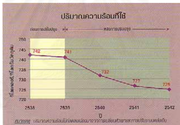
รูปที่ ข.31 แสดงการใช้พลังงานความร้อนของหม้อเผาก่อนและหลังปรับปรุง
