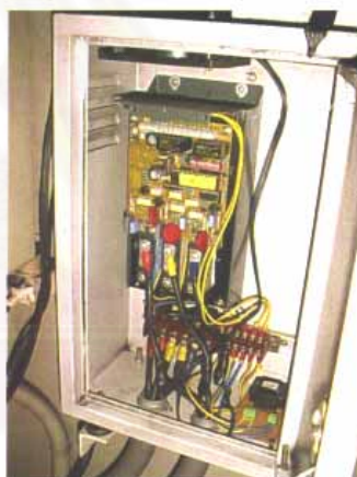
รูปที่ ข.9 แสดงการติดตั้งชุดควบคุมฯ ของเครื่องปั๊มโลหะ
