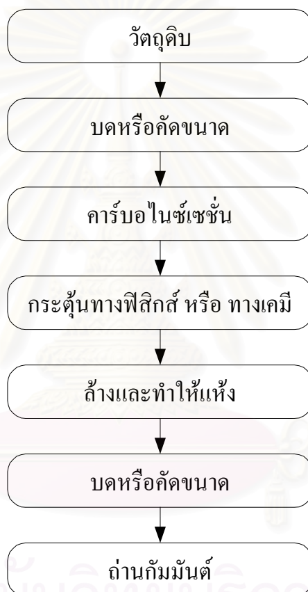
รูปที่ 2.6 กระบวนการผลิตถ่านกัมมันต์
