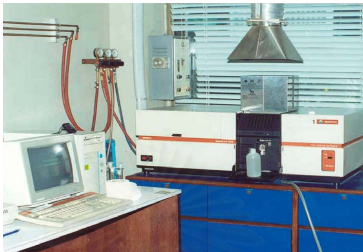
เครื่องอะตอมมิกแอบซอร์บชันสเปกโตรสโคปี (AAS) : Varian, Model SpectrAA-300, USA.
