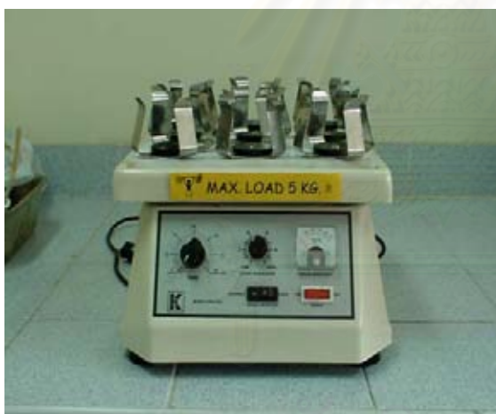
เครื่องเขย่า (shaker) ยี่ห้อ K รุ่น VRN-360
