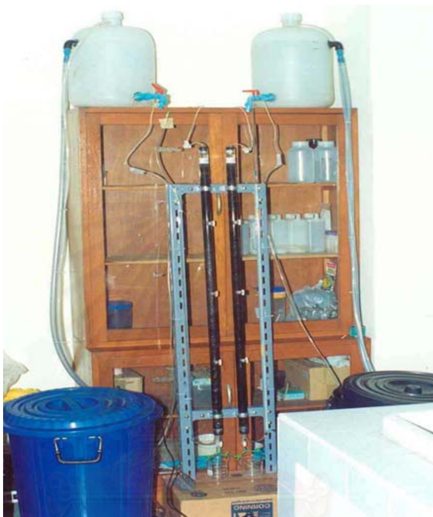
รูปที่ 3.2 ระบบถังดูดซับแบบแท่งที่ใช้ในการทดลอง
