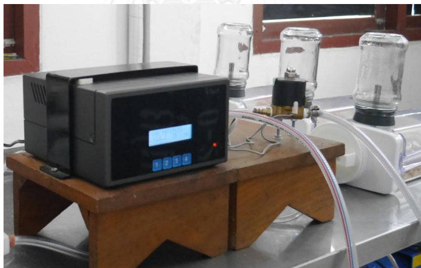
ภาพที่ 3.4 แสดงอุปกรณ์ในการควบคุมการจ่ายก๊าซอัตโนมัติในการสร้างแบบจำลอง chronic intermittent hypoxia
