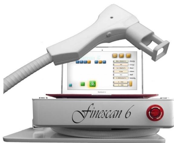
รูป 8 รูปภาพเครื่องเลเซอร์เออร์เปียมชนิดแบ่งส่วน ขนาดความยาวคลื่น 1550 นาโนเมตร
