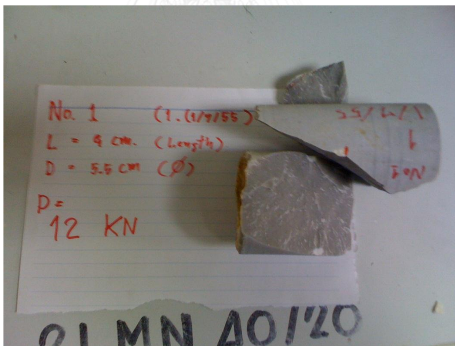
รูปที่ ก8 การแสดงแท่งตัวอย่างทรงกระบอกหลังการทดสอบ Point Load
