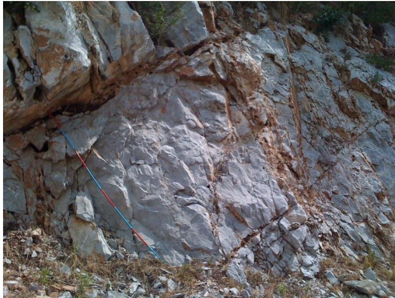
รูปที่ ก3 การแสดงการวัดความหนาของชั้นหิน
