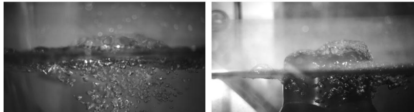
รูปที่ 4.25 ภาพแสดงลักษณะการกระจายตัวของฟองอากาศบริเวณผิวน้ำโดยเปรียบเทียบกับระบบที่ไม่ติดตั้งอุปกรณ์ (ซ้าย) และระบบที่ติดตั้งอุปกรณ์สร้างฟิล์มของเหลว (ขวา)
