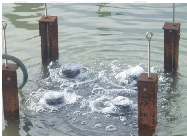
รูปที่ 2.4 ภาพแสดงการทำงานของอุปกรณ์สร้างฟิล์มของเหลว
