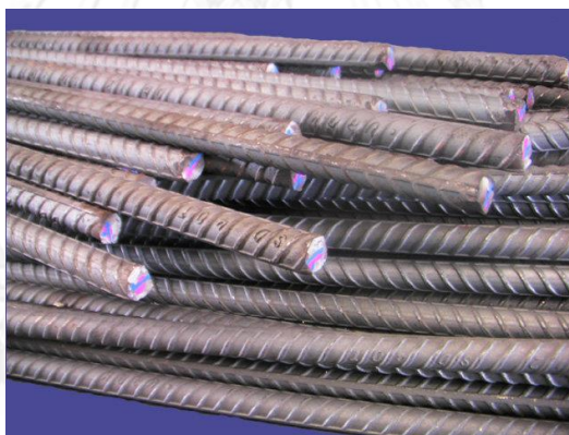
รูปที่ 4.26 เหล็กเสริมประเภท DB (ภาพจาก http://www.ss.co.th )
