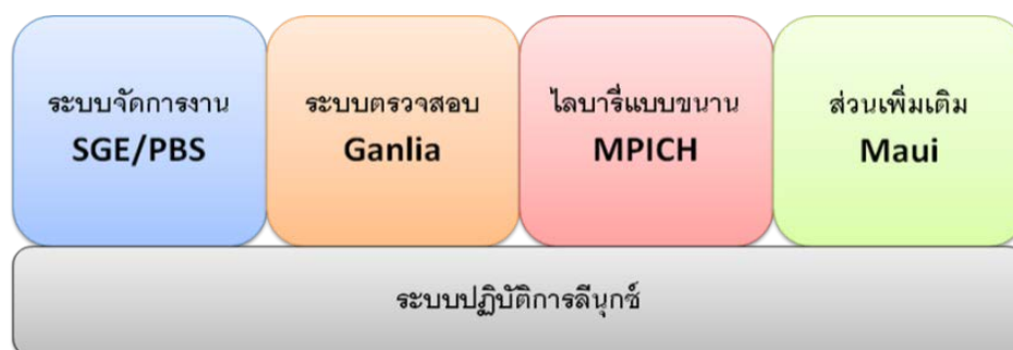
ภาพที่ 2.23 องค์ประกอบทางด้านซอฟต์แวร์ในระดับแนวคิดของร็อคคัลสเตอร์
