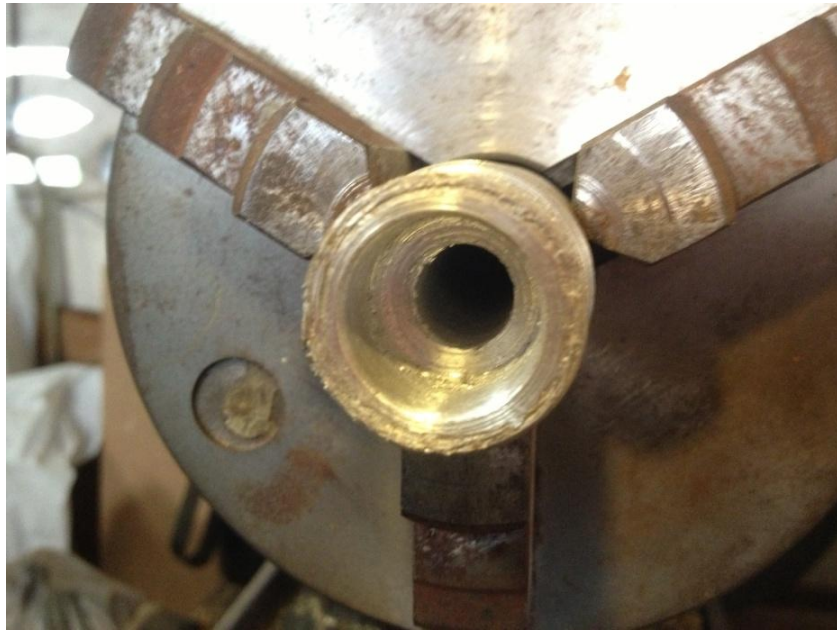
ภาพที่ ๑๓๘ ลักษณะอนุมิตินิยมที่ผ่านการเจาะด้วยสว่านให้ทะลุ
