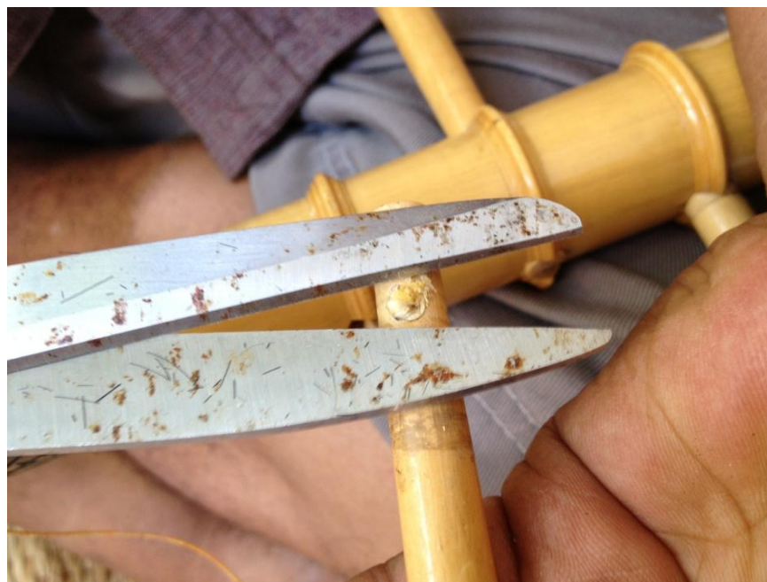
ภาพที่ ๒๕๕ การตัดแต่งเก็บปลายปม
