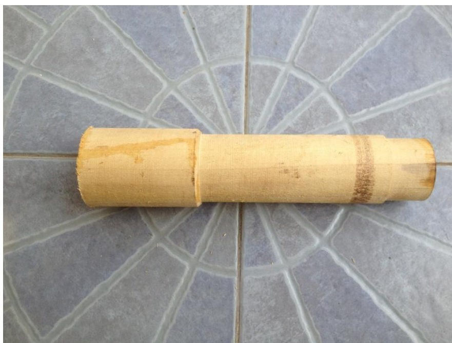
ภาพที่ ๑๑๙ ลักษณะการกลึงไม้ระดับท่อนยอดให้ไม้ระดับ
