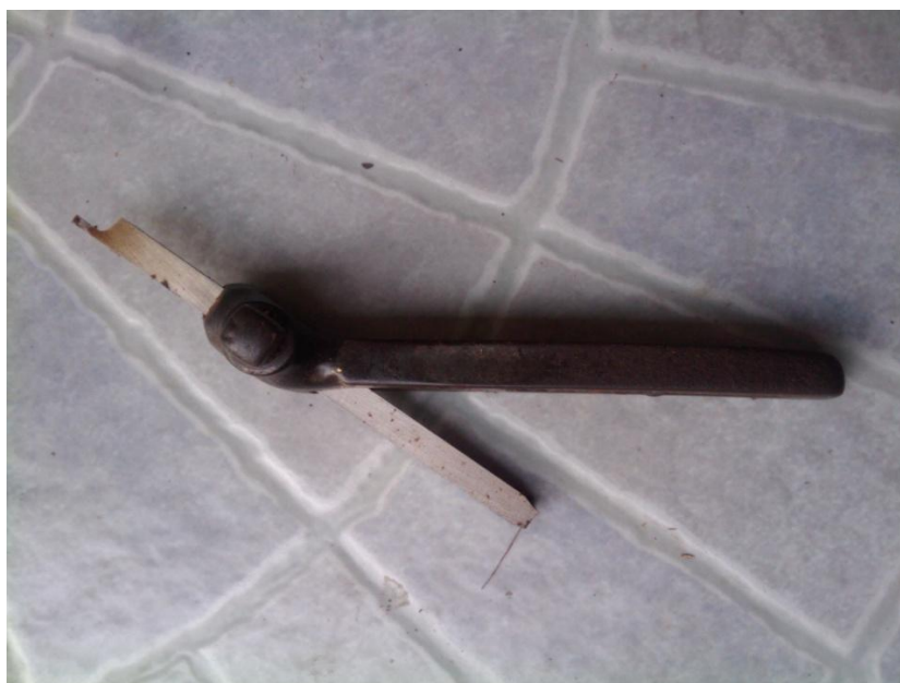
ภาพที่ ๘๗ ลักษณะการประกอบค้อนจับกับใบมีดงอไปทางขวา
