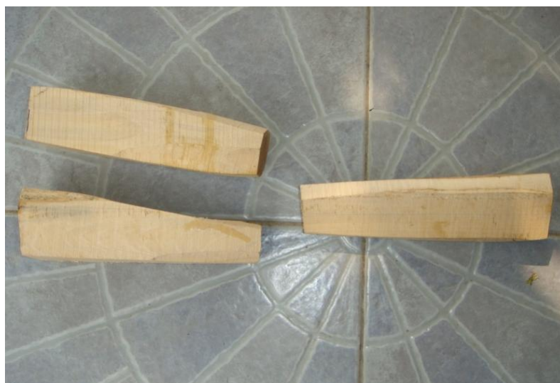
ภาพที่ ๑๘๖ ไม้ที่ใช้เตรียมในการกลึงลูกบิด
