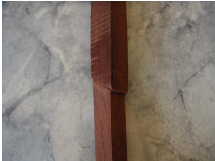
ภาพที่ ๑๖๔ รูปแบบการเหลาสลักแกนไม้
