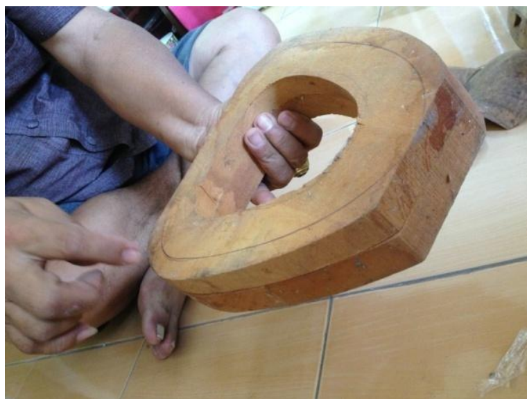
ภาพที่ ๒๔๗ การประกอบเชิงไม้ซ้อนกัน
