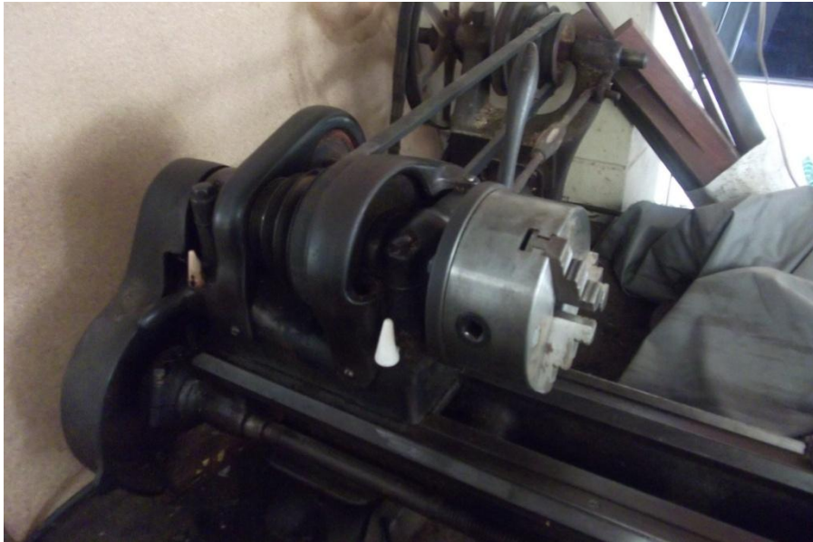
ภาพที่ ๕๒ หัวจับแบบสามจับ
