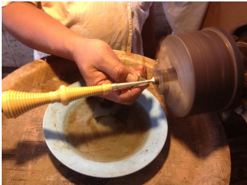
ภาพที่ ๑๖๕ การใช้กระดาศทรายน้ำขัดเงาปลายเข็มทองเหลือง
