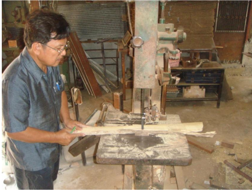
ภาพที่ ๒๐๗ การเลื่อยไม้ให้ได้สัดส่วนสำหรับเหลาคันชัก
