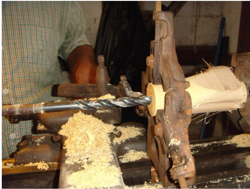
ภาพที่ ๑๒๘ การใช้สว่านเจาะส่วนหุ้มกะโหลกให้ทะลุ
