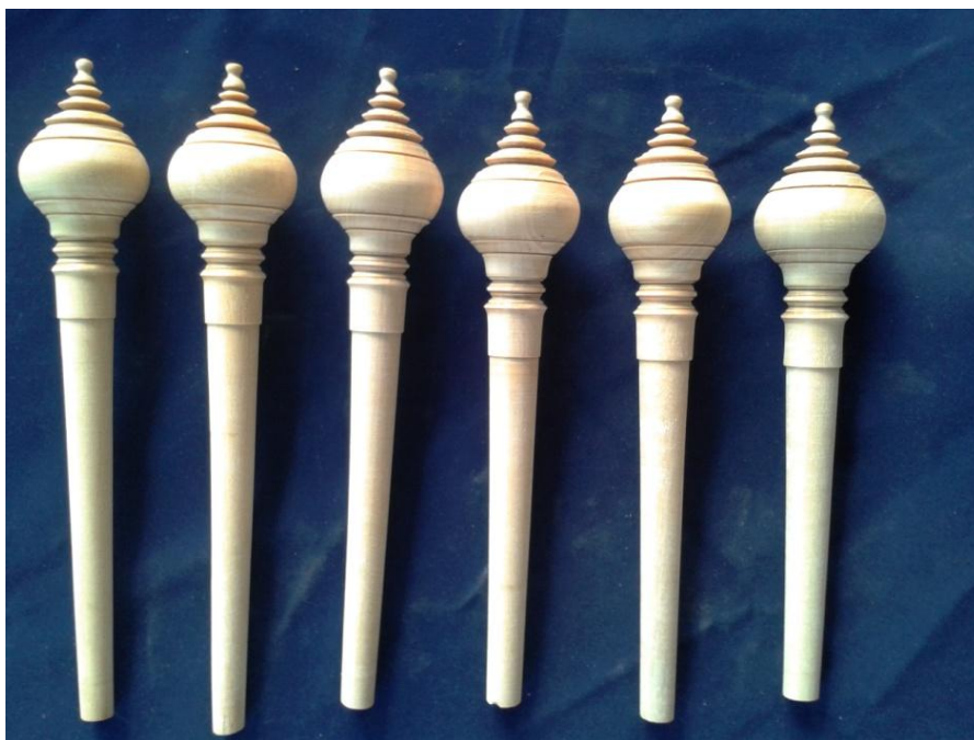
ภาพที่ ๑๘๔ ลักษณะของลูกบิดขอสามสายที่กลึงรูปทรงเรียบร้อยแล้ว
