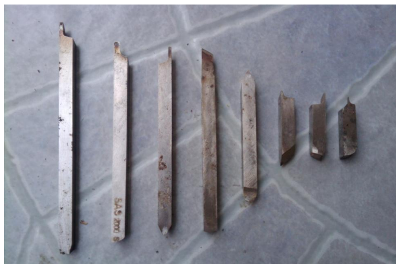
ภาพที่ ๘๕ ใบมีดที่เจียเป็นรูปแบบต่างๆ เพื่อกลึงขึ้นรูปลวดลายต่างๆบนซอด้วง
