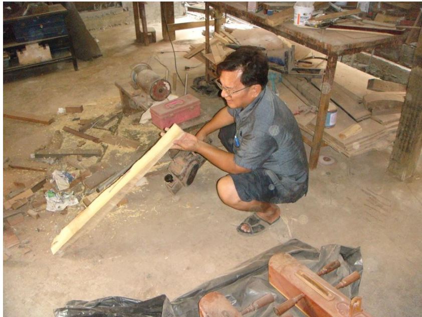
ภาพที่ ๒๐๑ การตรวจสอบความตรงของไม้
