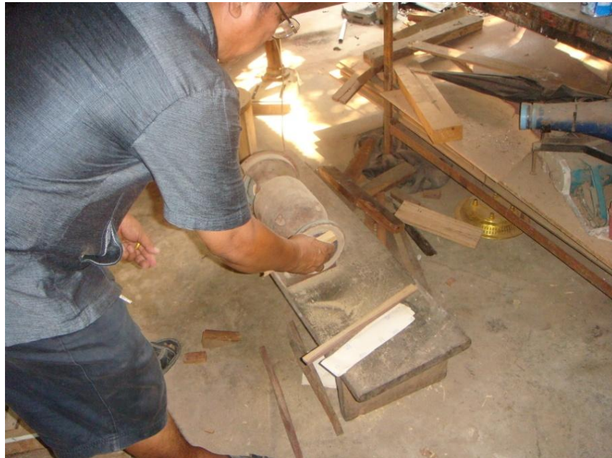
ภาพที่ ๒๕๑ การเจียรไม้พื้นขาห่องขอสามสาย
