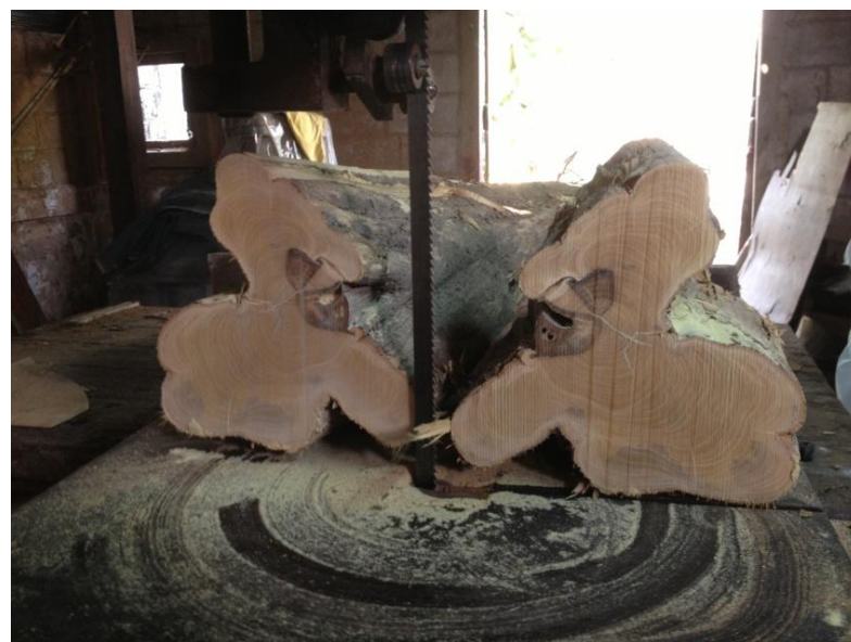
ภาพที่ ๑๐๗ ลักษณะการผ่าไม้ตรวจสอบคุณภาพเนื้อไม้
