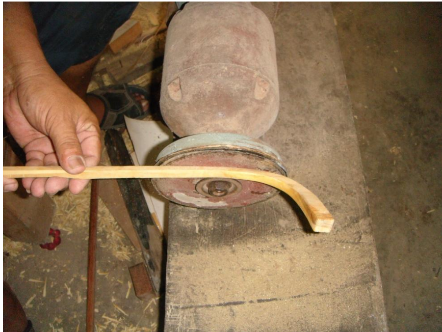
ภาพที่ ๒๑๒ ลักษณะของคันชักหลังผ่านการขัดแต่งด้ามให้เรียบ
