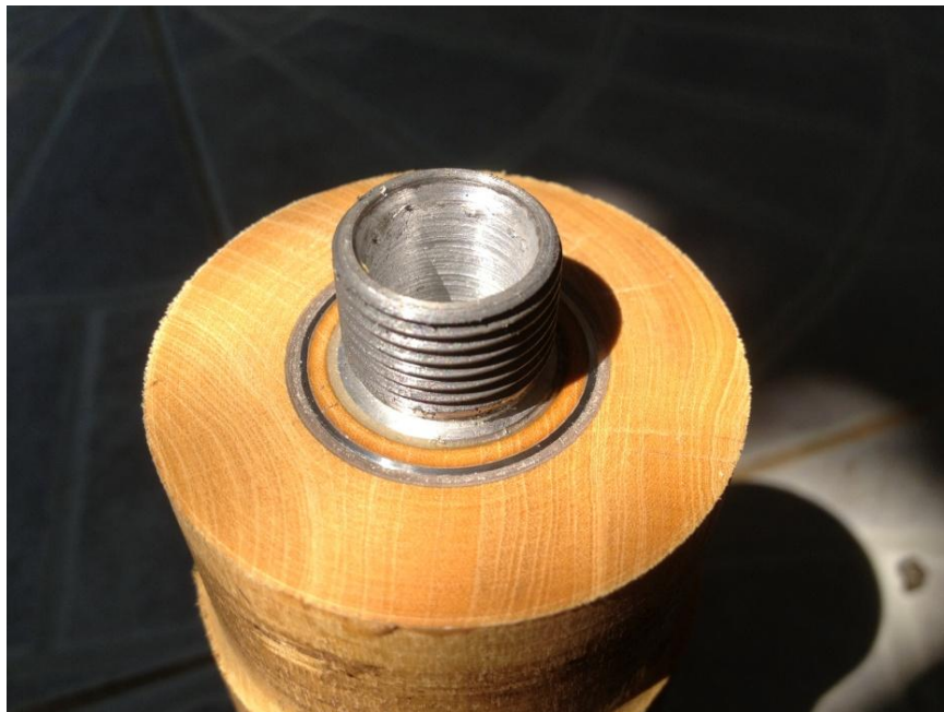
ภาพที่ ๓๔๒ ลักษณะการกลึงเข้าเกลียวตัวผู้ของครุวินิจ พุกสวัสดิ์
