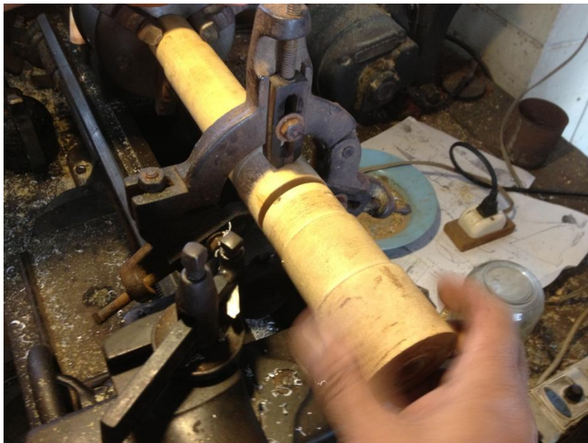
ภาพที่ ๑๔๘ การทดลองนำท่อนยอดที่มีเกลียวตัวผู้มาประกอบเข้าเกลียวตัวเมีย
