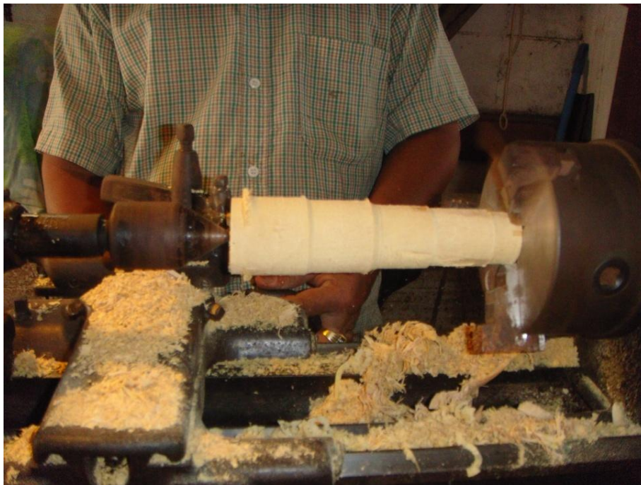
ภาพที่ ๑๓๐ การกรดถึงไถ่ระดับเท้าขอสามสายเพื่อให้ไม่เกิดความเรียว
