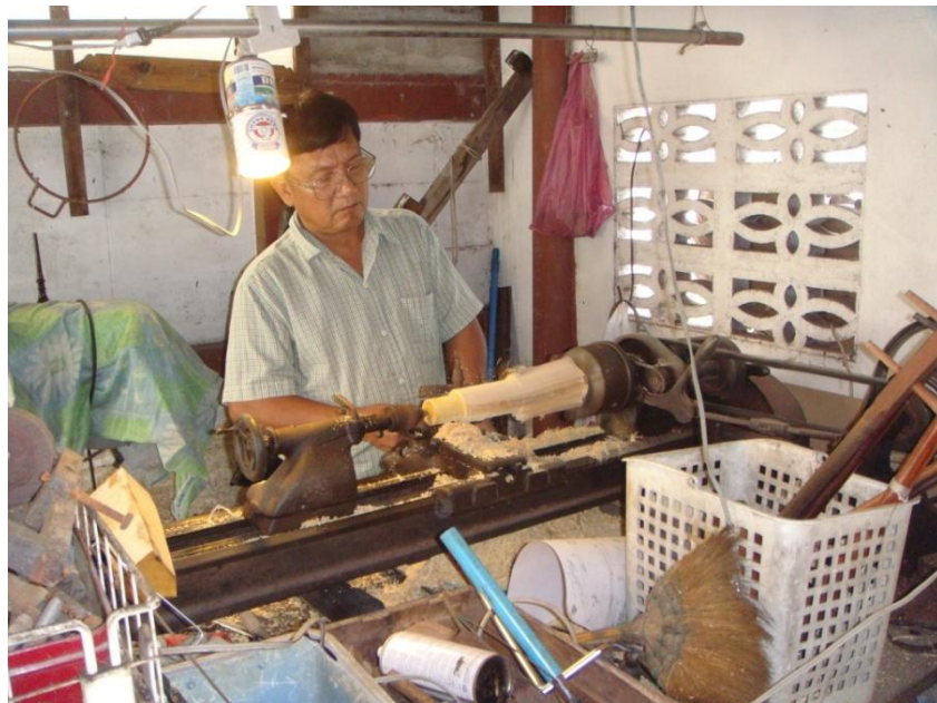
ภาพที่ ๑๒๒ การกลึงได้มือให้ไม้กลมเป็นระดับ
