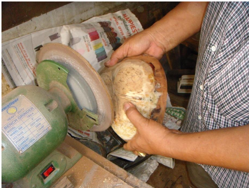
ภาพที่ ๒๕๔ การขัดแต่งด้วยเครื่องเจียร
