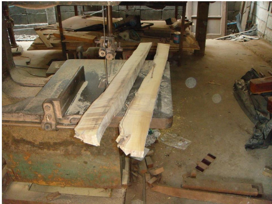
ภาพที่ ๒๐๕ ลักษณะไม้ที่ได้ (ชิ้นขวา) หลังการผ่าแบ่งเฉพาะส่วนที่ใช้เหลาคันชัก
