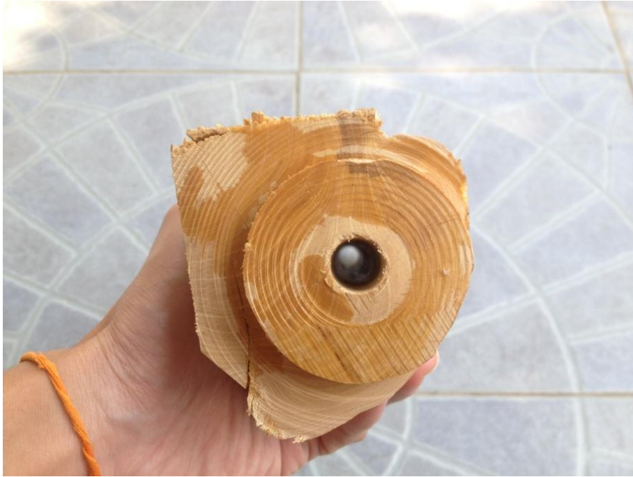
ภาพที่ ๑๒๕ ลักษณะรูของท่อนกลาง หรือพรมที่ใช้ดอกสว่านเจาะทะลุ
