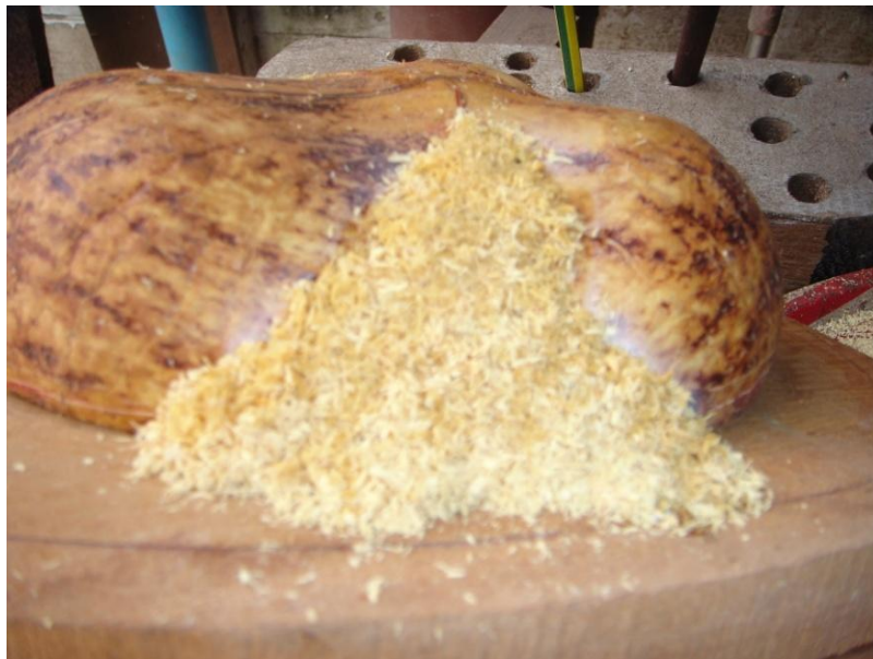
ภาพที่ ๒๕๒ การอุดประสานรอยลึ้มกะลาด้วยจี๊ดเยื่อผสมกาว
