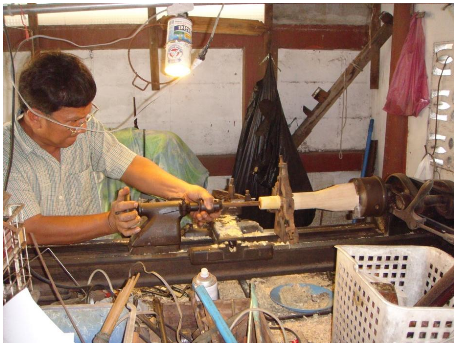
ภาพที่ ๑๒๔ การใช้ดอกสว่านเจาะท่อนกลางให้ทะลุ
