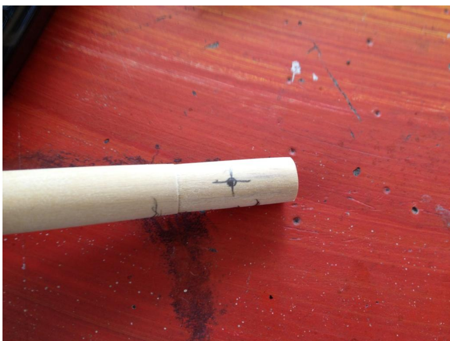
ภาพที่ ๑๕๖ การเขียนตำแหน่งเป็นเป้าเจาะรูร้อยสายลูกบิด
