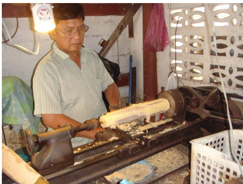
ภาพที่ ๑๑๗ การกลึงล้างช่วงท่อนยอดขอสามสาย
