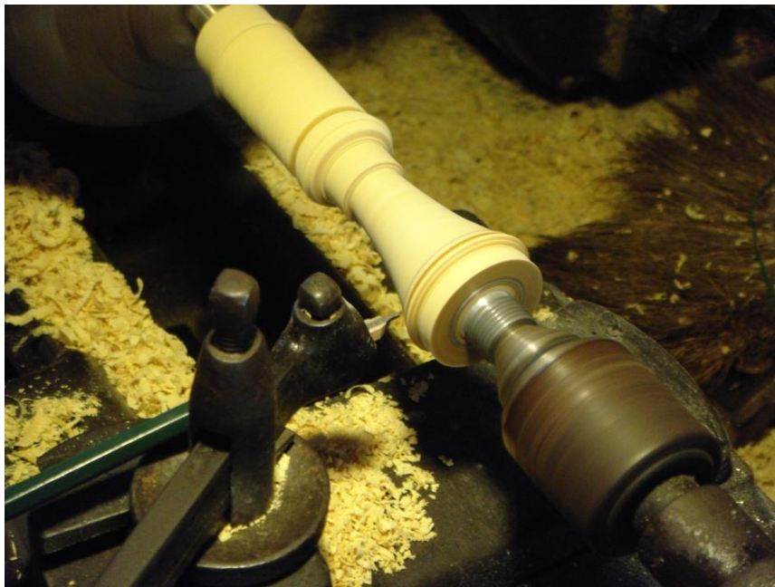
ภาพที่ ๑๖๑ การกลึงเข้ารูปให้เรียบในส่วนใต้หุ้มกะโหลก
