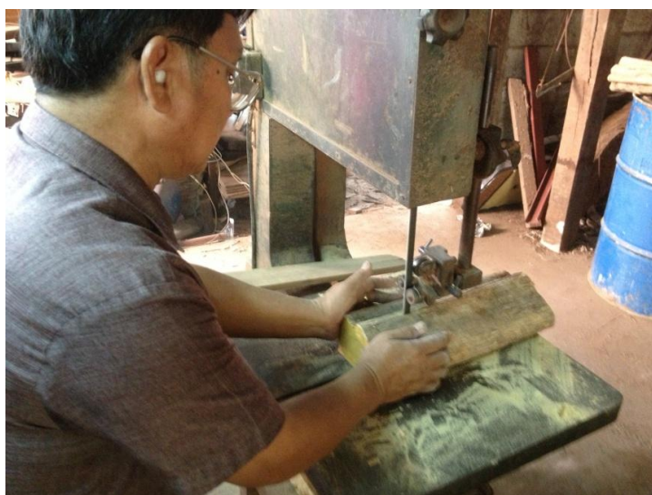
ภาพที่ ๑๑๒ การผ่าแยกไม้สำหรับกลึงท่อนยอดและท่อนกลาง
