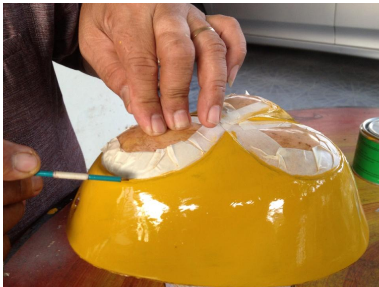
ภาพที่ ๒๗๕ การทำรักหลังกะโหลกซอสามสาย
