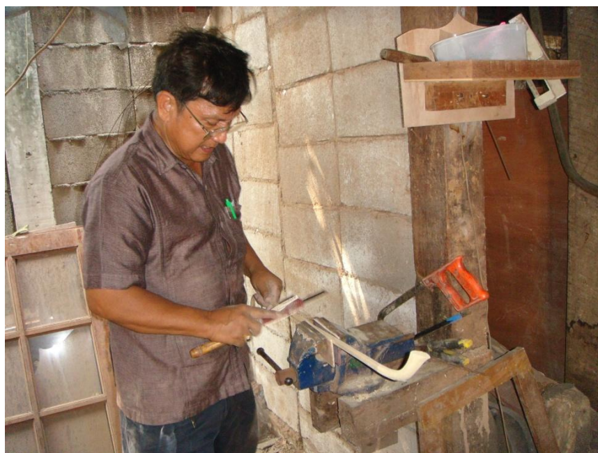
ภาพที่ ๒๑๓ การใช้ตะไบหุ้มทาบด้วยกระดาษทรายหยาบขัดแต่งให้ด้ามกลมมน
