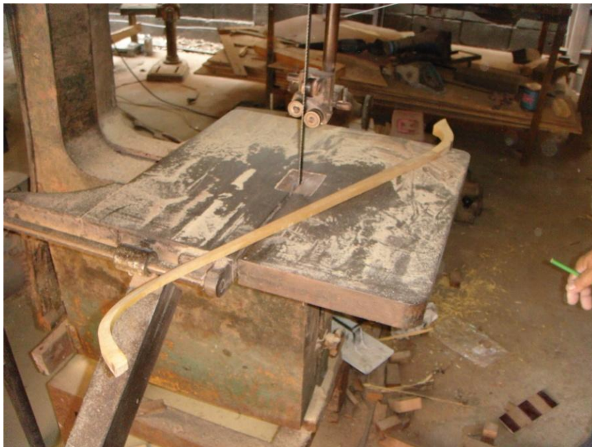
ภาพที่ ๒๐๕ ลักษณะไม้ที่ได้หลังจากการเลื่อยตามแบบ
