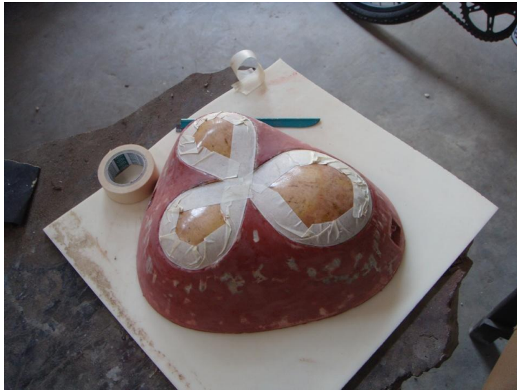
ภาพที่ ๒๗๔ การทำสีรองพื้นหลังกะโหลกซอสามสาย
