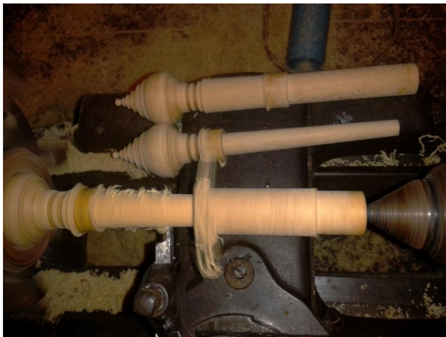
ภาพที่ ๑๘๓ การกลึงลดขนาดช่วงก้านลูกบิด
