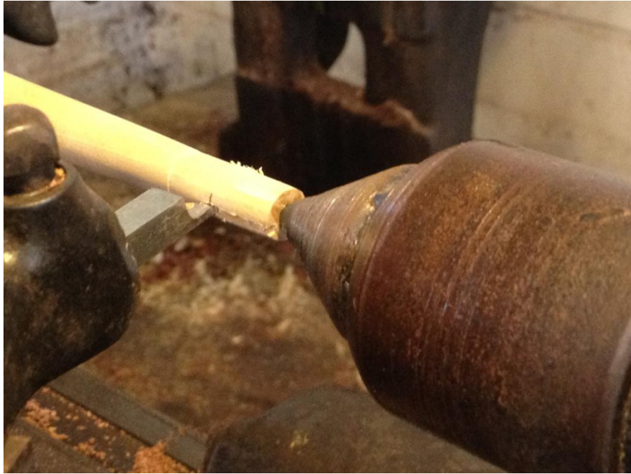
ภาพที่ ๒๐๑ การเซาะร่องทำรางสาย
