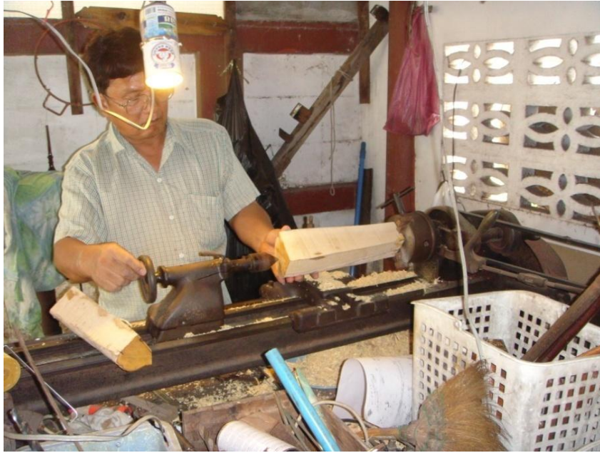
ภาพที่ ๑๒๑ การกลึงล้างท่อนเหยียบกะโหลกเพื่อให้ไม้กลม
