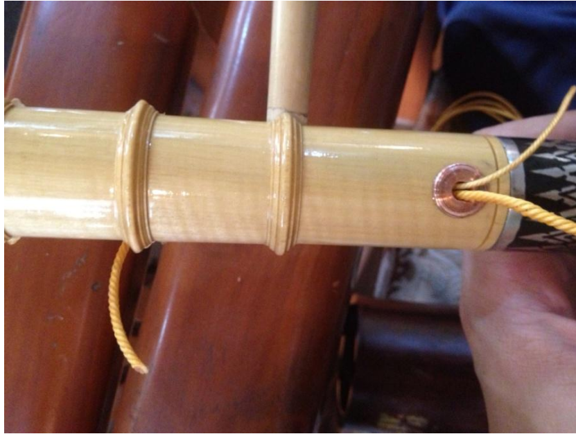
ภาพที่ ๒๕๒ การร้อยสายทึ่มออกกรูเสียบลูกบิด
