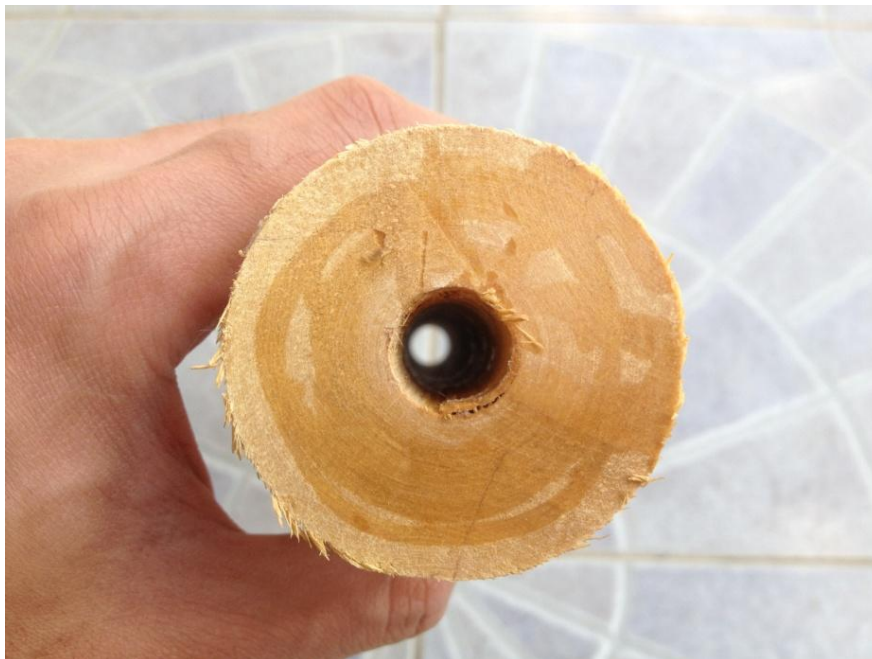
ภาพที่ ๑๒๐ ลักษณะรูที่เจาะท่อนยอดทะลุด้วยดอกสว่าน
