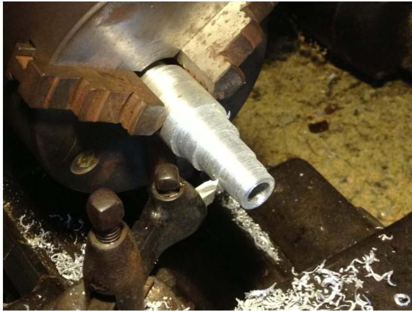
ภาพที่ ๑๕๒ การกลึงอลูมิเนียมสำหรับเตรียมเกลียวตัวผู้
