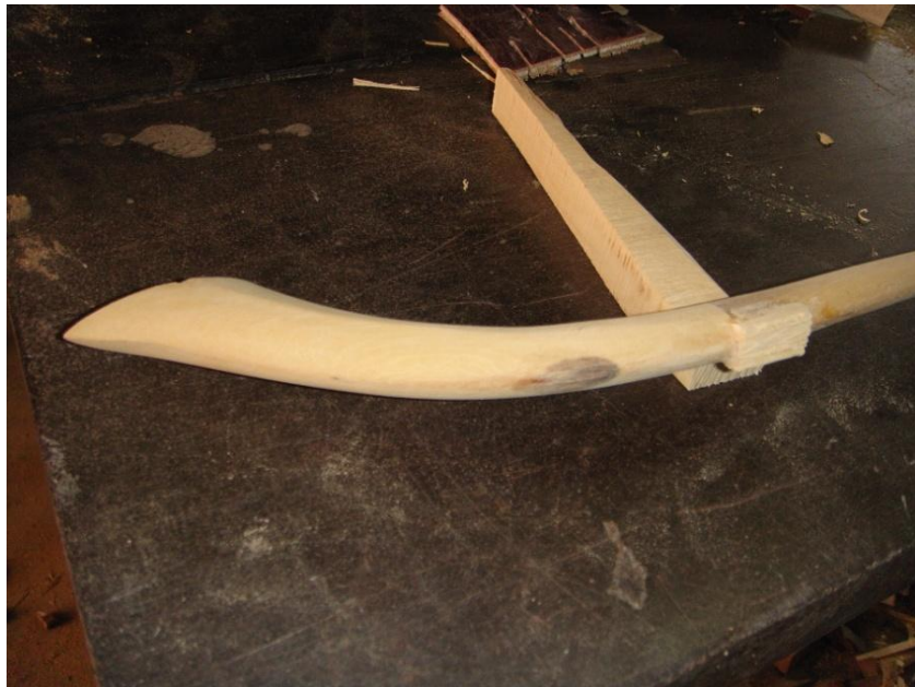
ภาพที่ ๒๑๔ การนำไม้มาเสริมจุดผูกหางม้าเพื่อช่วยในการใช้นิ้วสอดจับคันทัก
