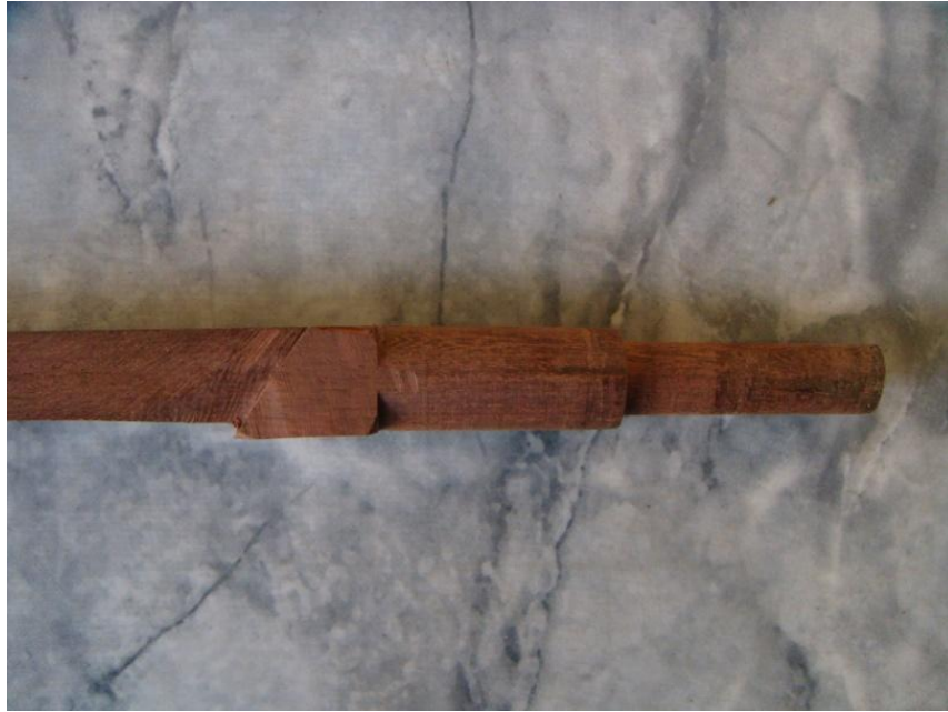
ภาพที่ ๑๗๐ ลักษณะแกนไม้ในส่วนของสลักและส่วนที่ใช้เสียบรูปปากช้าง
