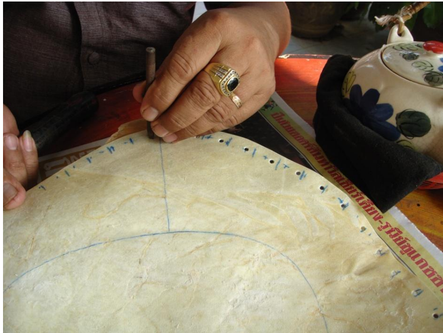
ภาพที่ ๒๖๗ ลักษณะการเจาะรูด้วยเหล็กเจาะหนัง
