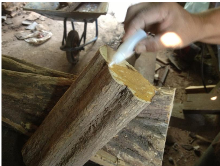
ภาพที่ ๑๐๘ การใช้กาวร้อนหยอดรอยร้าวของเนื้อไม้
