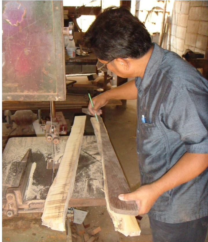
ภาพที่ ๒๐๖ การวาดแบบสำหรับเตรียมเลื่อยไม้คันทันชัก
