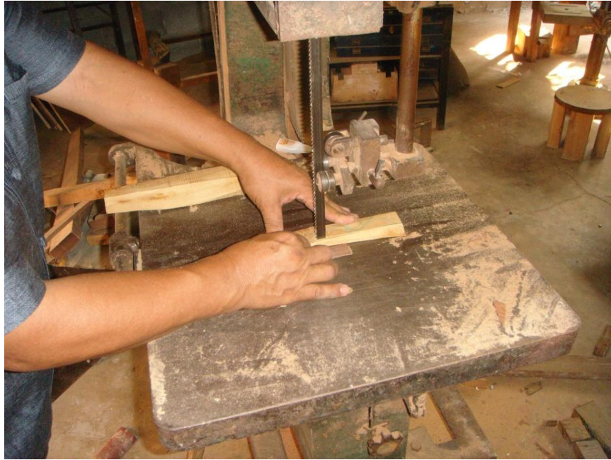
ภาพที่ ๒๕๐ การเลื่อยไม้ทำห่องขอสามสาย
