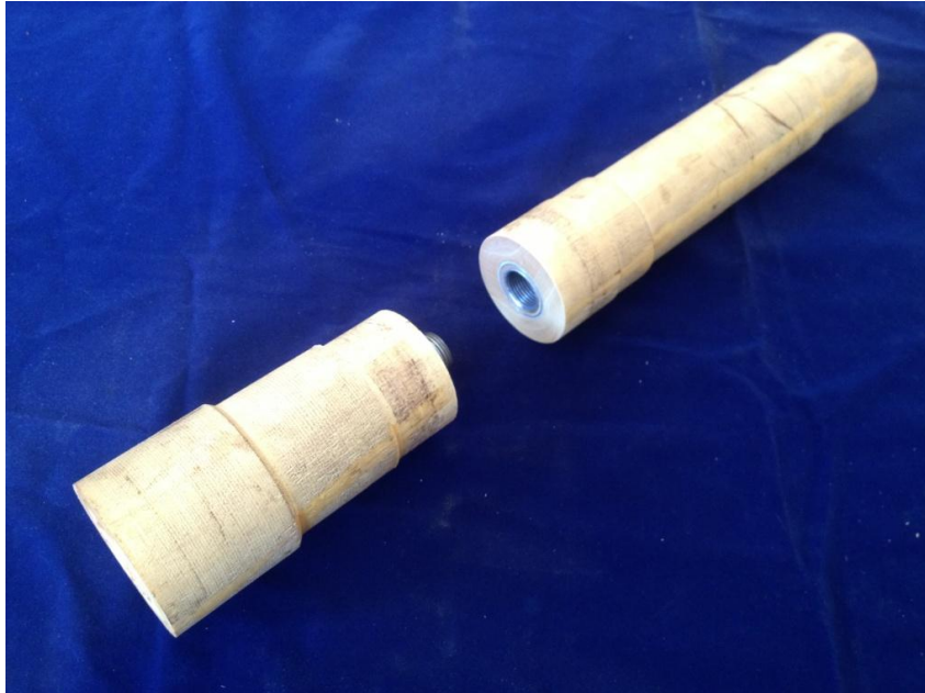
ภาพที่ ๑๕๑ ลักษณะของชุดเกลียวในช่วงพ่อนยอด
