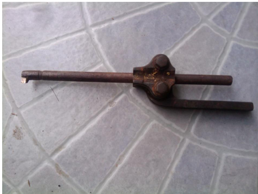
ภาพที่ ๕๑ ลักษณะการประกอบใบมีดคว้านกับค้ำจับ
