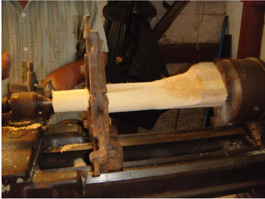
ภาพที่ ๑๒๓ ลักษณะของท่อนกลางที่ผ่านการกลึงแล้ว
