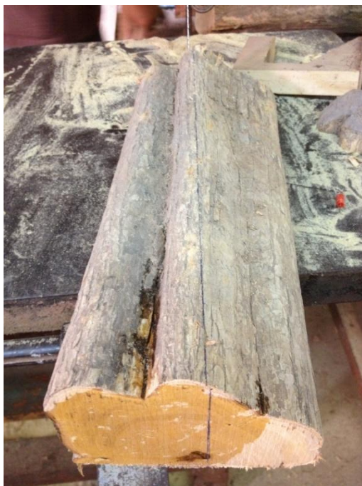
ภาพที่ ๑๑๑ การเขียนตำแหน่งในการผ่าแบ่งเพื่อใช้กลึงท่อนยอด และท่อนกลาง
