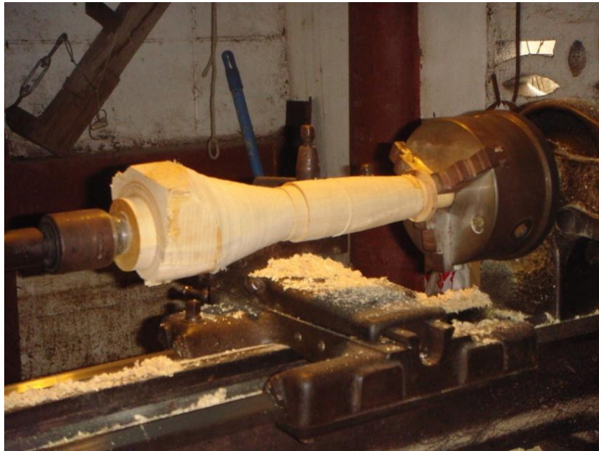
ภาพที่ ๑๕๘ การกลึงเข้รูปก่อนกลึงลูกแก้วท่อนกลาง
