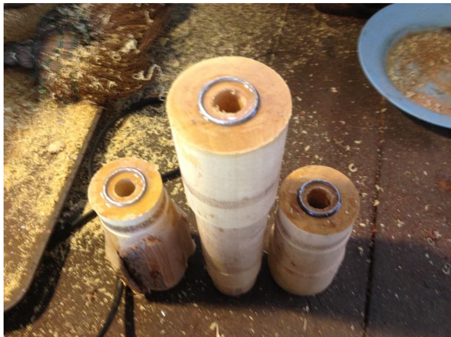
ภาพที่ ๑๓๕ ลักษณะของแหวนที่ติดกาวเรียบร้อยแล้ว
