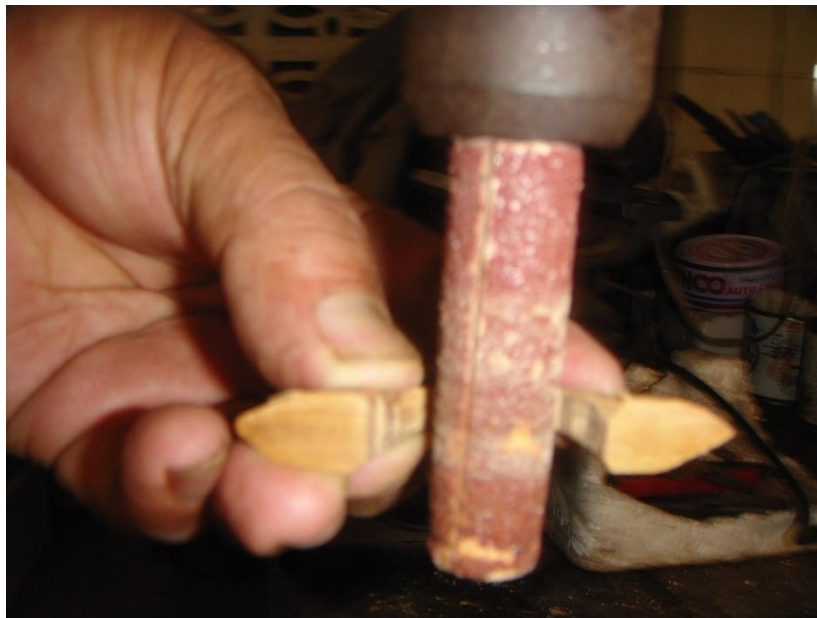
ภาพที่ ๒๘๓ การขัดแต่งความเว้าได้หย่องขอสามสาย
