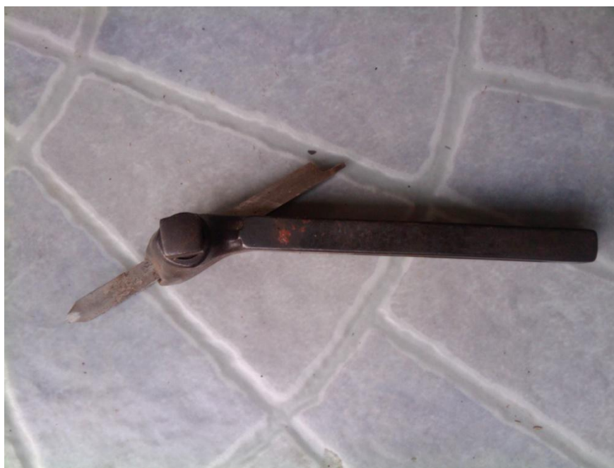
ภาพที่ ๘๙ ลักษณะการประกอบค้อนจับกับใบมีดงอไปทางขวา
