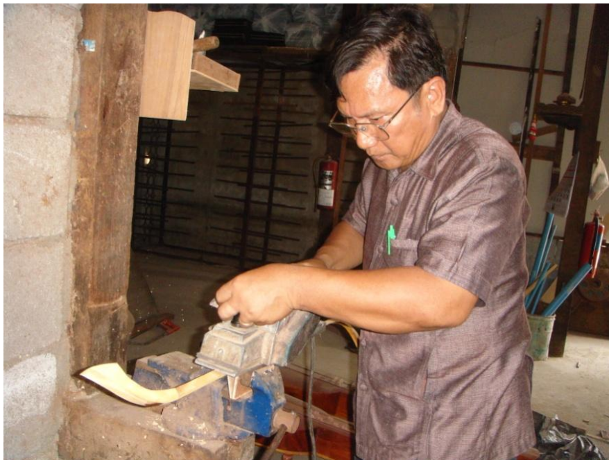
ภาพที่ ๒๑๐ การใช้กบไสไม้เพื่อการตกแต่งความเรียบร้อยของเนื้อไม้คันทันชัก
