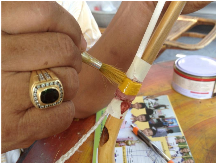
ภาพที่ ๒๒๖ การใช้รักเหลืองทาทับสีโป้วที่เชือกพันหางม้าโคนคันทัก
