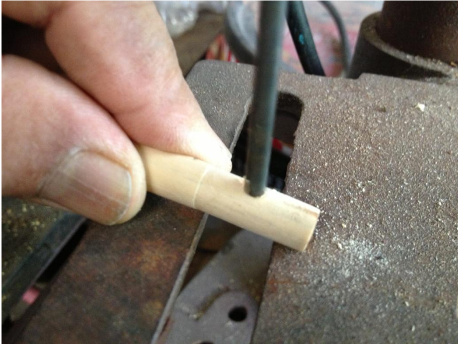
ภาพที่ ๑๕๕ การเจาะไม้ด้วยสว่านที่มีขนาดใหญ่กว่ารูร้อยสาย
