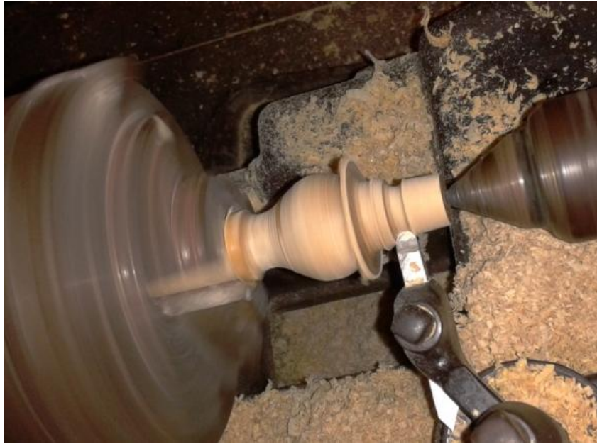
ภาพที่ ๑๕๐ การใช้ใบมีดปลายโค้งเข้ารูปให้ได้ลักษณะงานกลึงตามต้องการ
