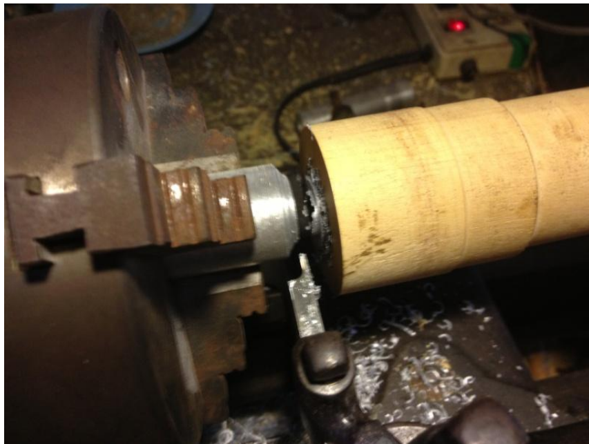
ภาพที่ ๑๔๑ การตัดลูมเนียมเกลียวตัวเมียหลังจากใส่เข้าไปในไม้ที่เตรียมแล้ว
