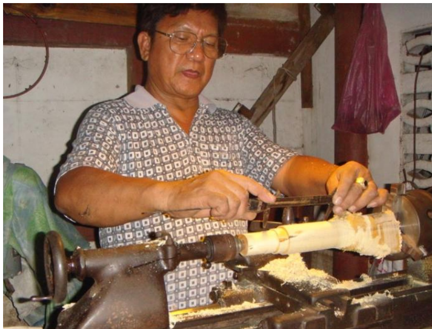
ภาพที่ ๑๕๗ การกำหนดระยะกลึงลูกแก้วท่อนกลาง
