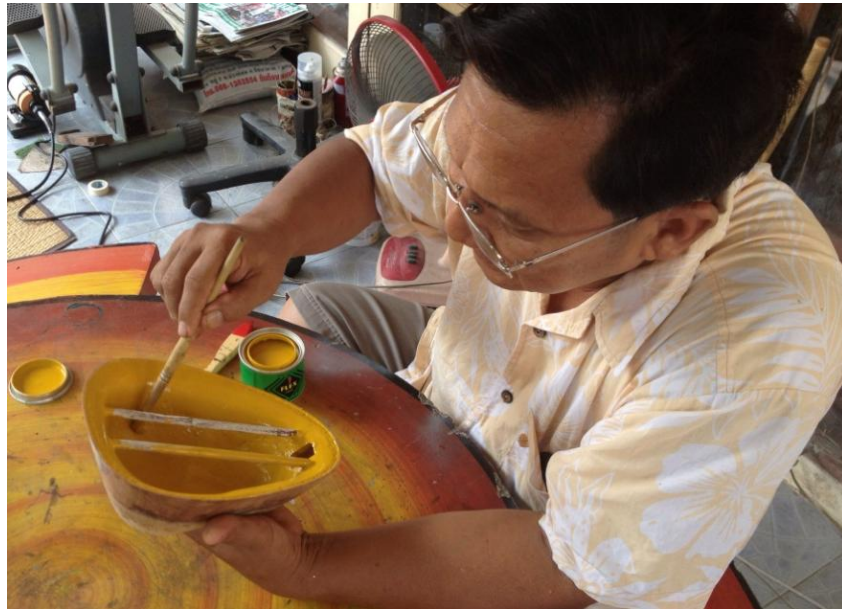
ภาพที่ ๒๕๙ การลงรักภายในกะโหลกขอสามสาย
