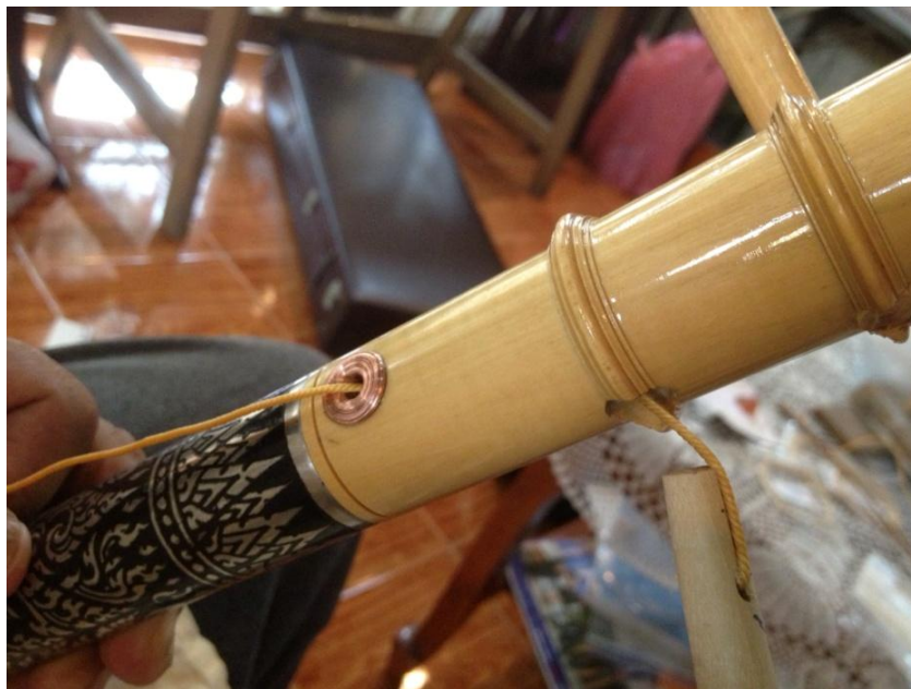
ภาพที่ ๒๕๑ ลักษณะการร้อยสายให้ผ่านออกรูเสียบลูกบิดสายเอก
