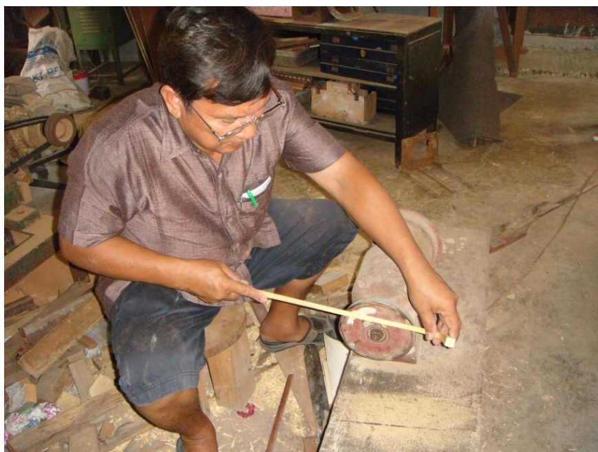
ภาพที่ ๒๑๑ การใช้เครื่องเจียรขัดแต่งคันทันชักให้ด้ามเรียบ
