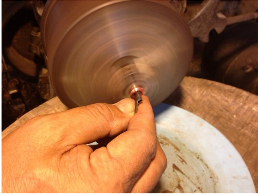
ภาพที่ ๑๘๒ การใช้กระดาษทรายน้ำขัดผิวให้เรียบ
