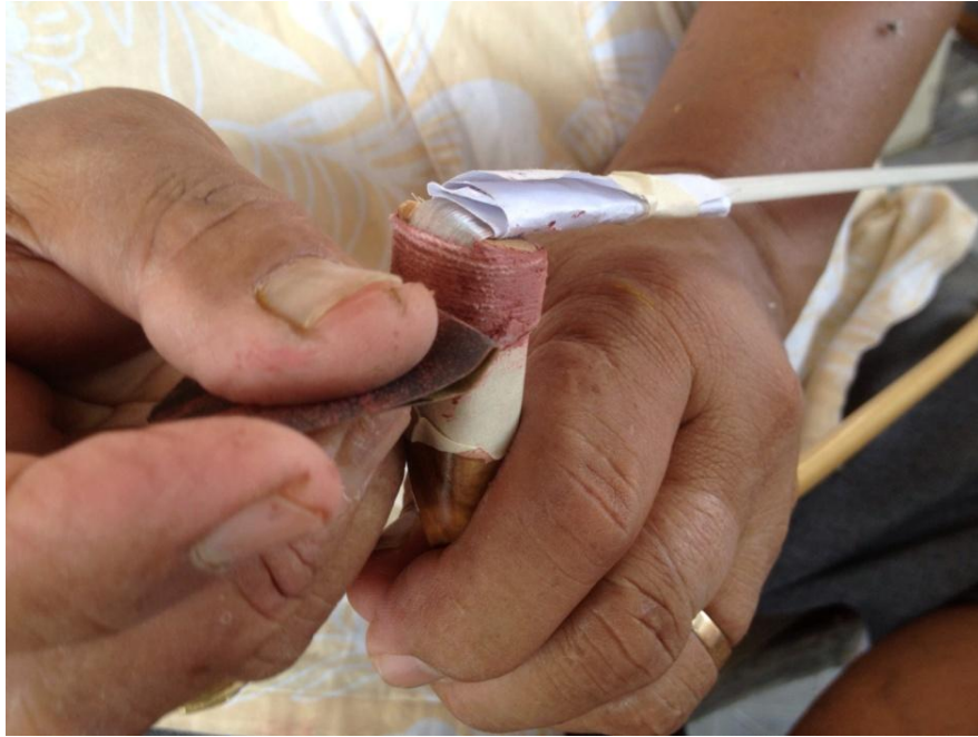
ภาพที่ ๒๒๔ การใช้กระดาดทรายขัดสีรองพื้นให้เรียบ
