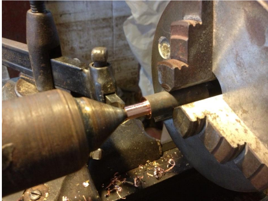
ภาพที่ ๑๘๐ การกลึงช่องร้อยสายขอและช่องร้อยหนดพราหมณ์
