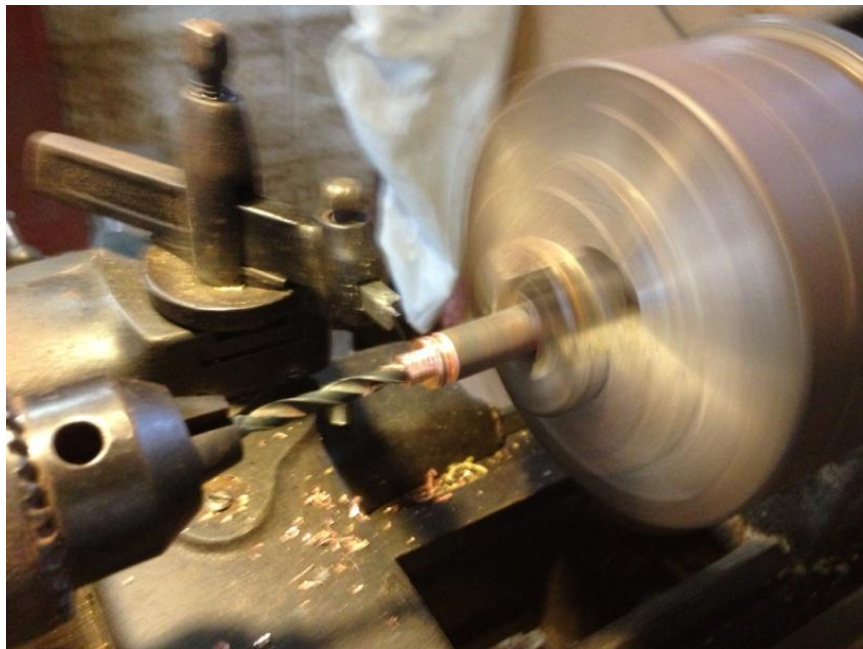
ภาพที่ ๑๘๑ การใช้สว่านเจาะแกนให้กลวง
