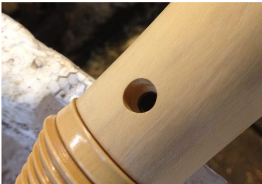
ภาพที่ ๑๘๔ รูที่เจาะเตรียมไว้ใส่ช่องโลหะ
