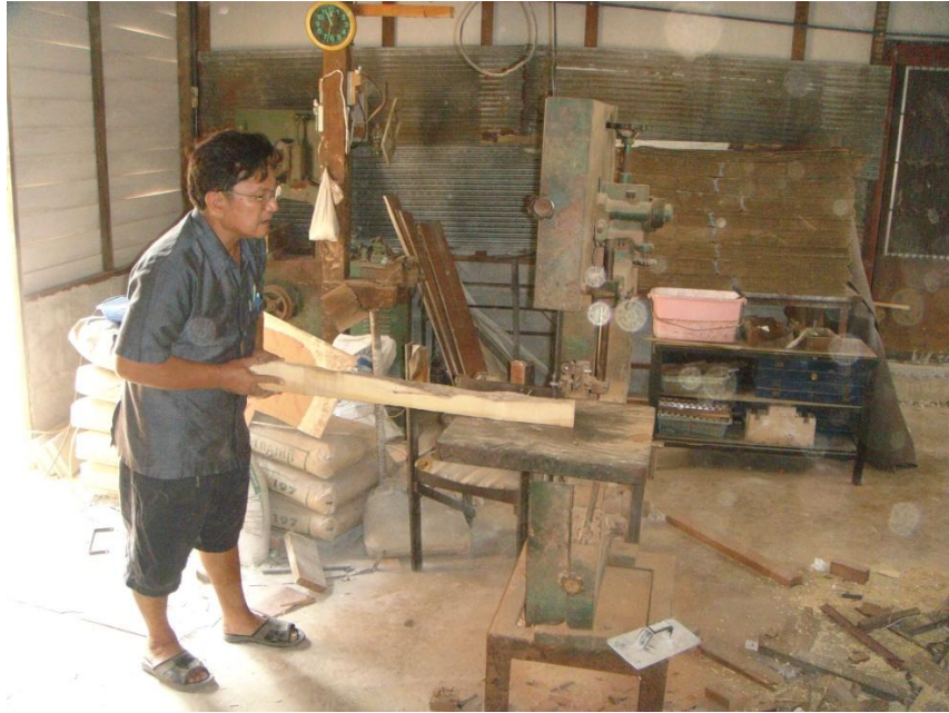
ภาพที่ ๒๐๔ การผ่าไม้เพื่อแบ่งส่วนที่ใช้เหลาคันชักมีความหนาประมาณ ๑ นิ้ว
