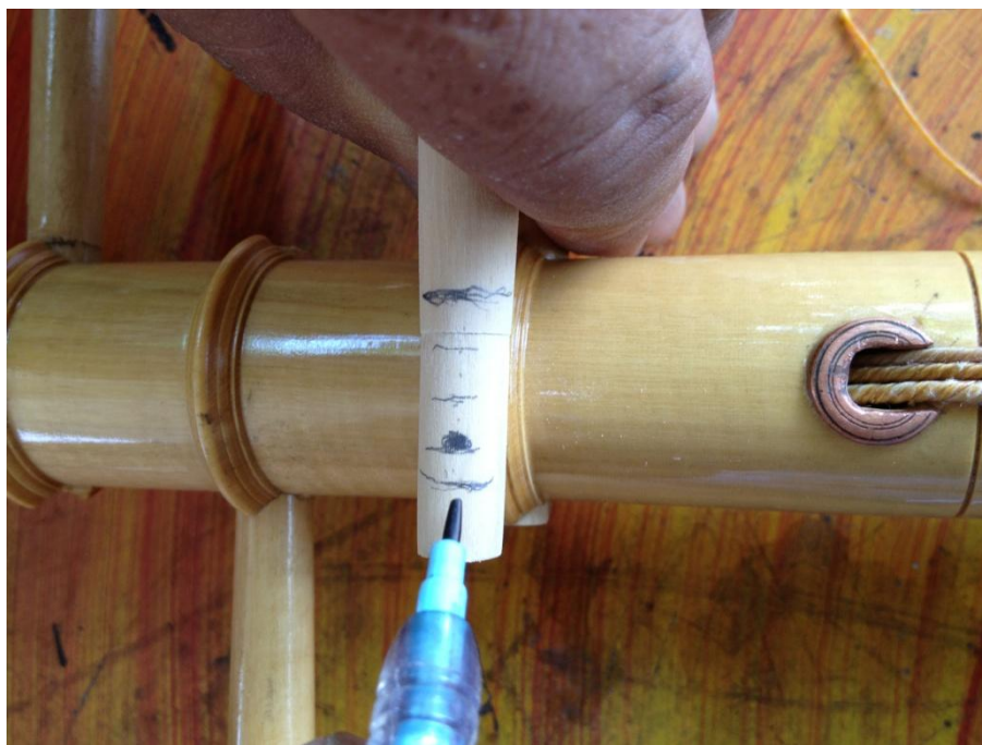
ภาพที่ ๑๕๕ การคำนวณหาตำแหน่งรูร้อยสายลูกบิด
