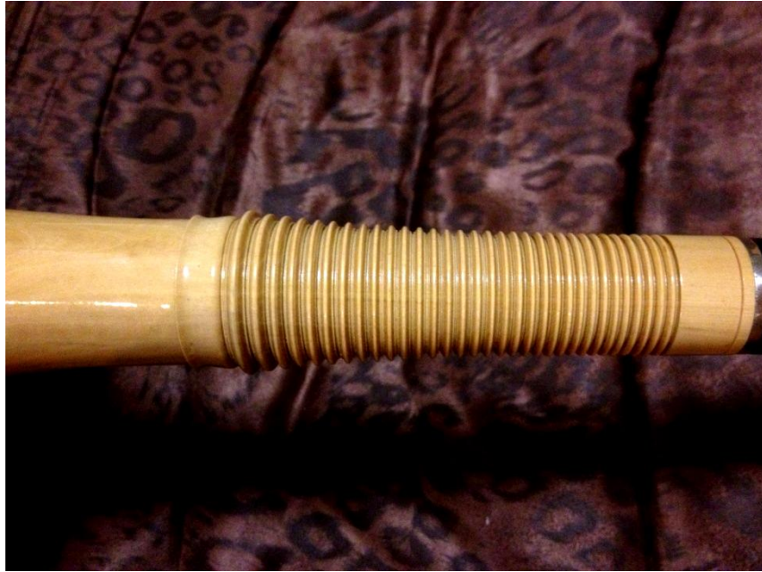
ภาพที่ ๑๖๐ ลักษณะลูกแก้วท่อนกลางที่กลึงเรียบรื้อแล้ว
