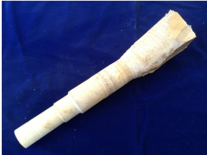
ภาพที่ ๑๕๔ ลักษณะการประกอบเข้าเกลียวช่วงเท้าซอสามสายหรือหุ้มกะโหลก
