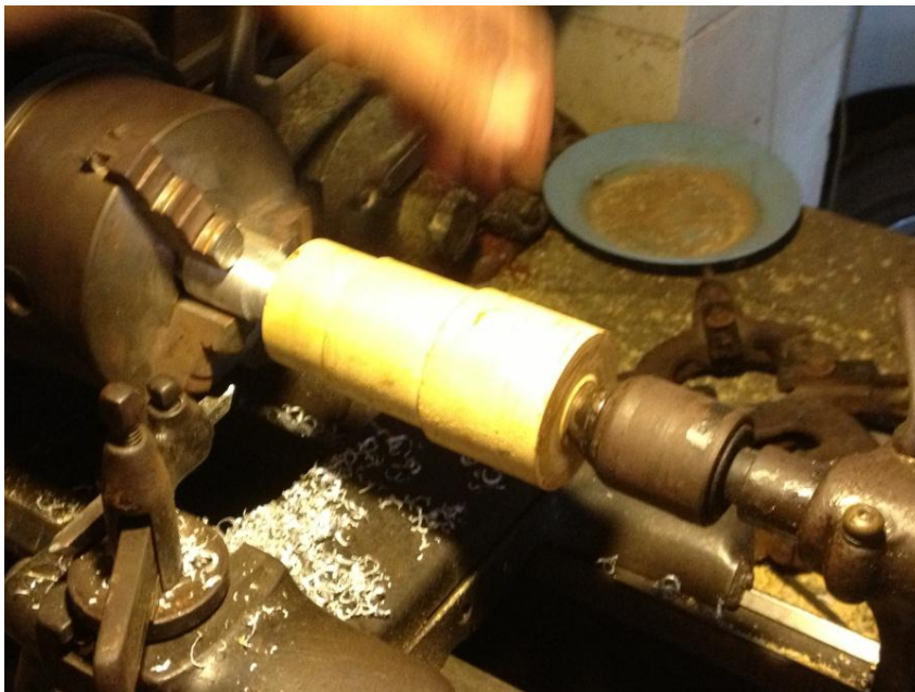
ภาพที่ ๑๕๓ การใส่อลูมิเนียมสำหรับเกลียวตัวผู้เข้าไปที่เนื้อไม้
