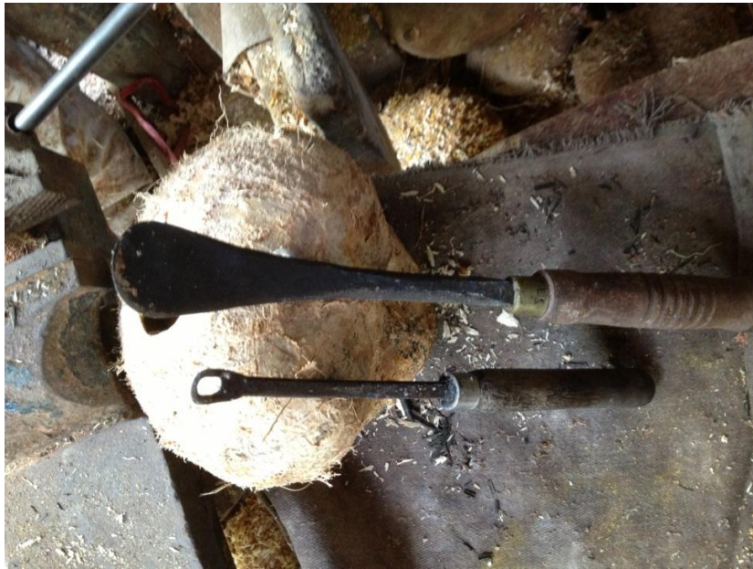
ภาพที่ ๖๘ ชุดเครื่องมือสำหรับแชะเนื้อมะพร้าวตามแต่ละขนาด
