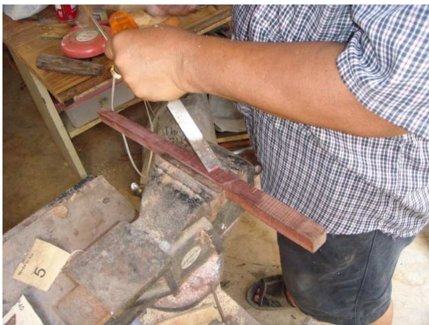
ภาพที่ ๑๖๗ การใช้ส่วเหลาเพื่อให้ได้แกนไม้ที่มีสลักกลมเฉียง
