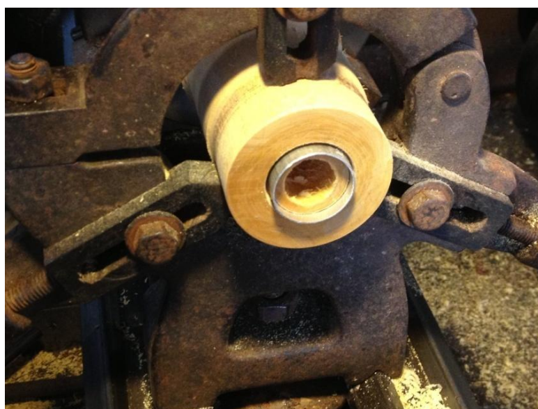
ภาพที่ ๑๓๓ การนำแหวนอลูมิเนียมมาใส่ในร่องที่ได้กลึงเตรียมไว้
