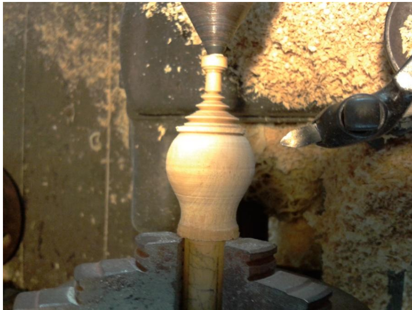
ภาพที่ ๑๕๑ การใช้ใบมีดปลายแหลมในการกลึงรูปทรงของลูกบิด
