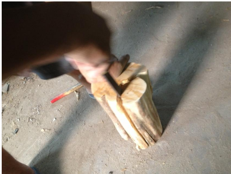
ภาพที่ ๑๑๔ การใช้ลิ้มในการแยกผ่าส่วนเนื้อไม้
