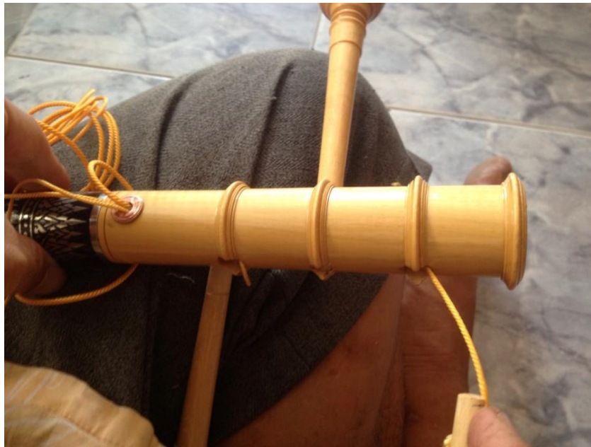
ภาพที่ ๒๕๓ การร้อยสายกลางออกกรูเสียบลูกบิด
