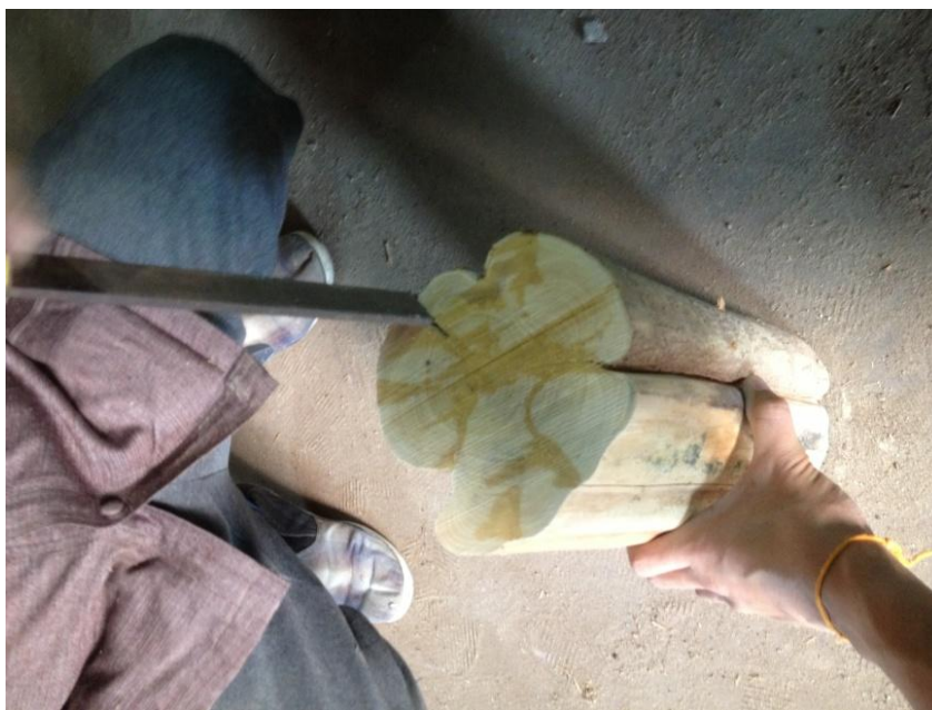
ภาพที่ ๑๑๓ การผ่าไม้โดยไม่ใช้เลื่อย
