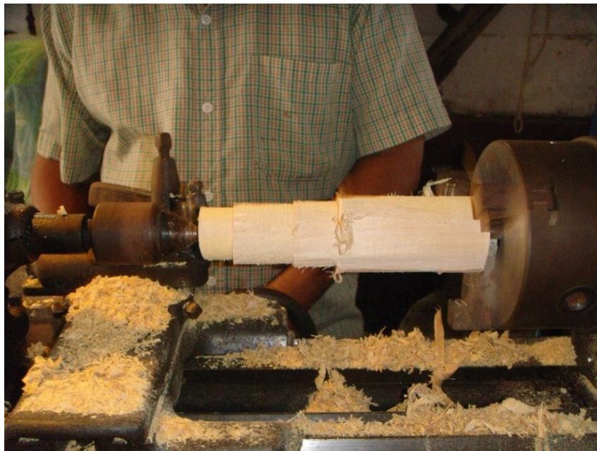
ภาพที่ ๑๒๙ การกลึงไม้ระดับเท้าขอสามสาย
