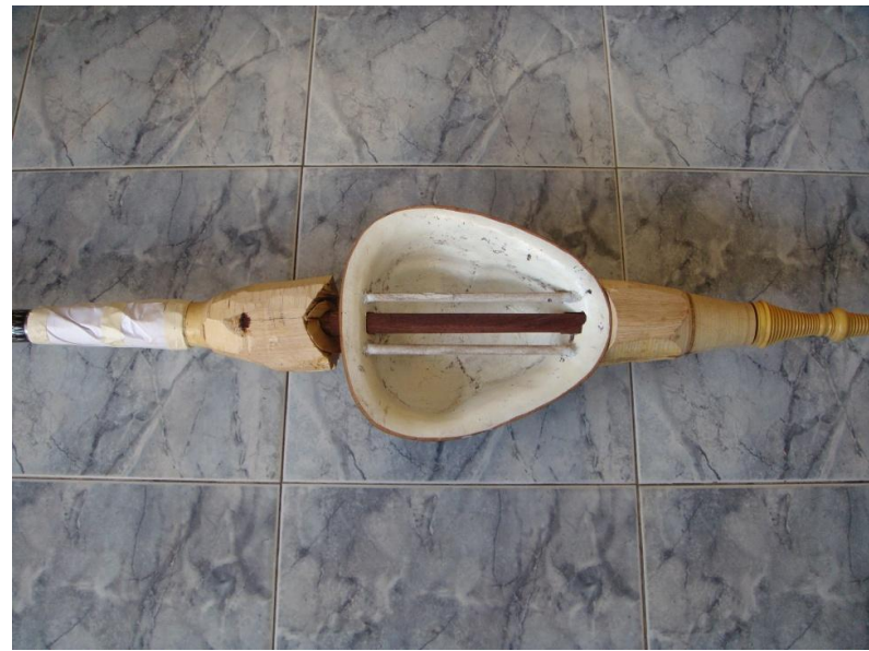
ภาพที่ ๑๓๕ การทดสอบแกนไม้เข้ากับเชิงกะโหลก ปากซ้างบนและปากซ้างล่าง
