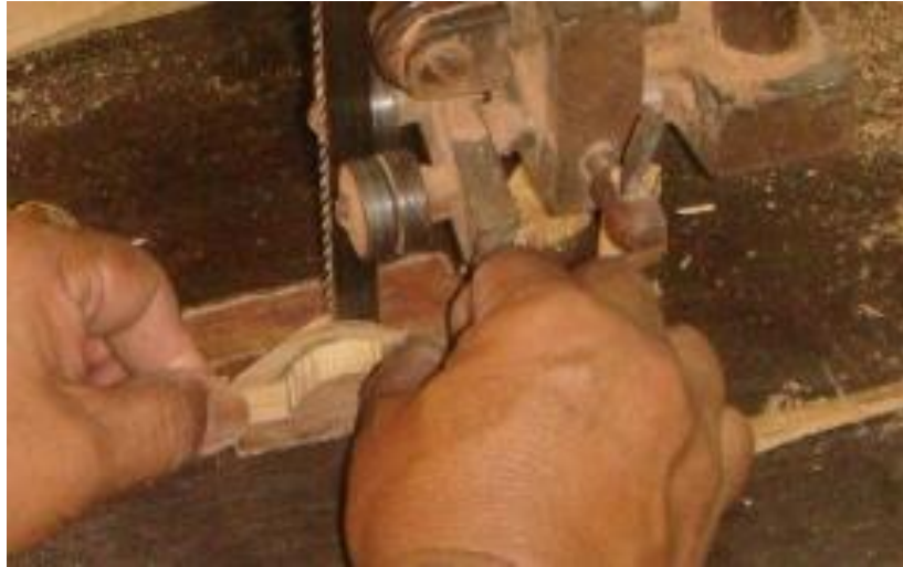
ภาพที่ ๒๘๒ การเลื่อยฉลุเข้ารูปหย่องขอสามสาย
