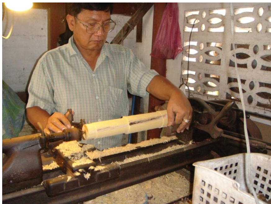
ภาพที่ ๑๑๘ การกลึงด้ามไม้ระดับท่อนยอดซอสามสาย
