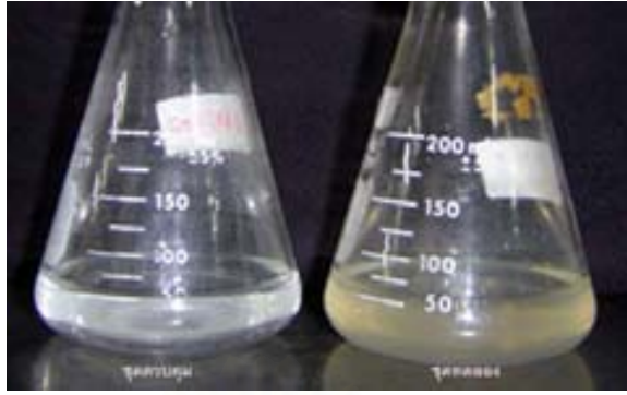
รูปที่ 4.1 ลักษณะสีของอาหารเหลว CFMM ที่เติมไฟรีน เมื่อมีการเจริญของแบคทีเรียจากตัวอย่างดินบริเวณรางรถไฟ จังหวัดนครราชสีมา เป็นเวลา 10 วัน
