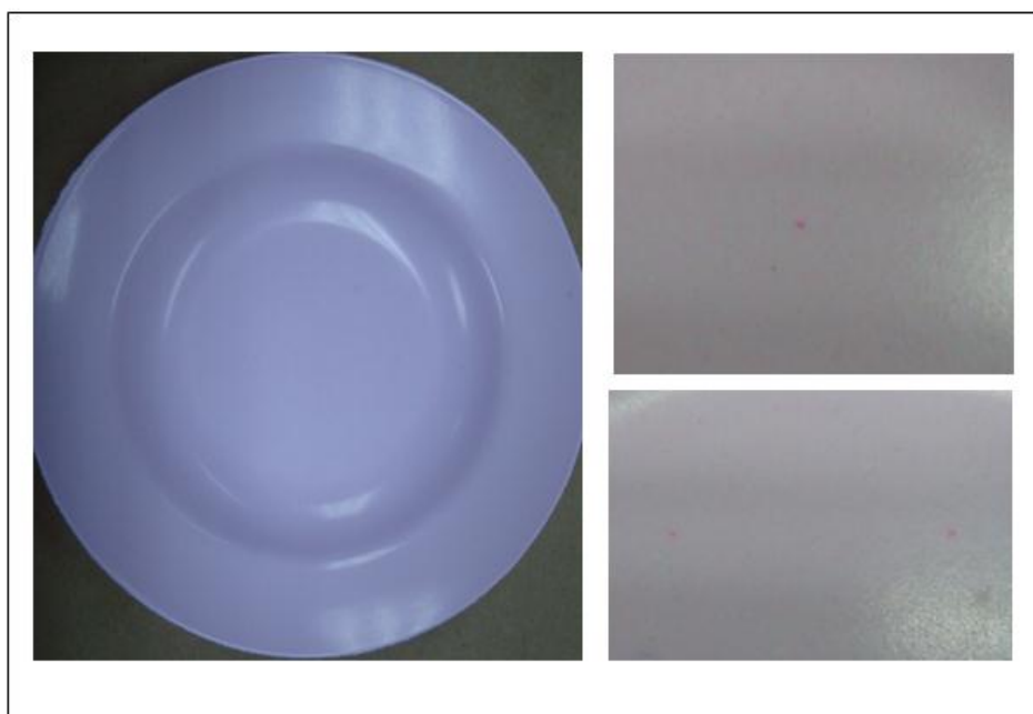
รูปที่ 1.7 ลักษณะจุดสิ่งแปลกปลอมบนชิ้นงานขึ้นรูปของผลิตภัณฑ์เม็ดพลาสติกกลุ่ม AU2020Y
