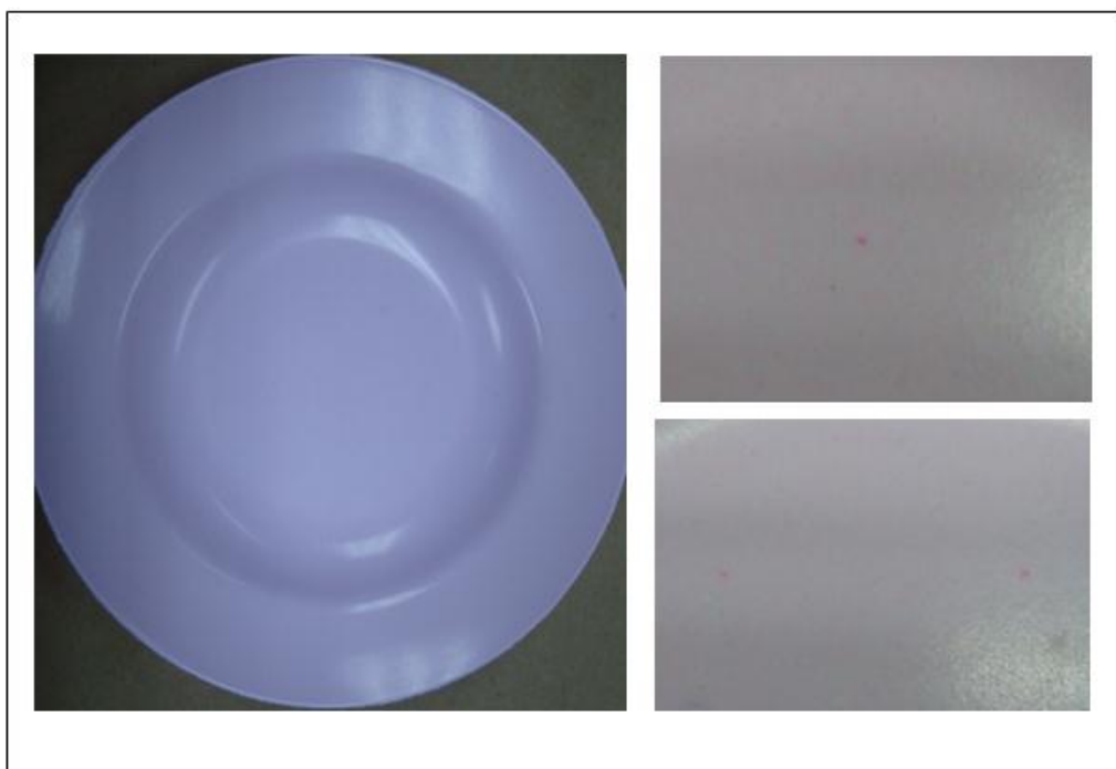
รูปที่ 3.6 ลักษณะจุดสิ่งแปลกปลอมบนชิ้นงานขึ้นรูปของผลิตภัณฑ์เม็ดพลาสติกกลุ่ม AU2020Y
