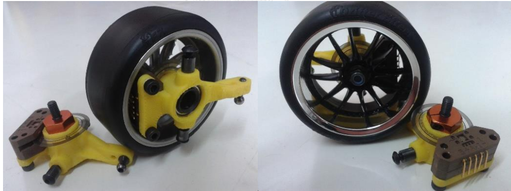
รูปที่ 4.16 การประกอบชิ้นส่วนต้นแบบกับแผ่นจาน US Digital Disk-1 และล้อมาตรฐาน 1:10
