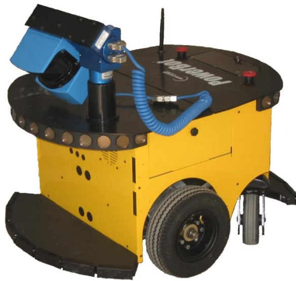
รูปที่ 2.1 ตัวอย่างของหุ่นยนต์ขับเคลื่อนแบบดิฟเฟอเรนเชียล (differential drive) [37]
