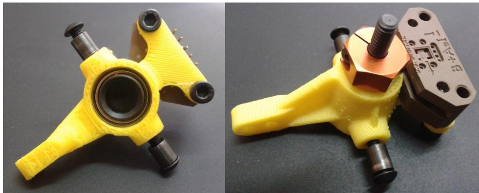
รูปที่ 4.15 การประกอบชิ้นส่วนต้นแบบเข้ากับเซ็นเซอร์ US Digital EM1-1-1250
