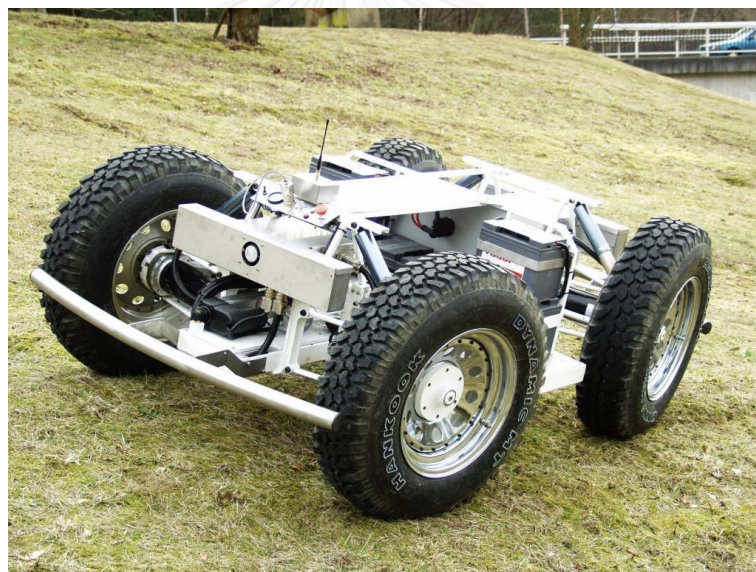
รูปที่ 2.2 ตัวอย่างของหุ่นยนต์ที่มีระบบเลี้ยวแบบรถยนต์ (Ackermann steering) [38]
