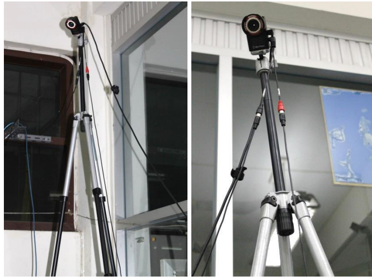
รูปที่ 5.2 กล้องวิดีโอบันทึกภาพ OptiTrack-Flex3 สำหรับระบุตำแหน่งและทิศทางของฐานขับเคลื่อนซึ่งเคลื่อนที่บนระนาบในพื้นที่ทดสอบ
