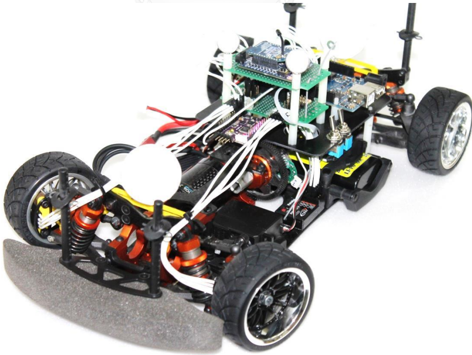
รูปที่ 4.1 ต้นแบบของฐานขับเคลื่อนบนระนาบที่พัฒนาขึ้น
