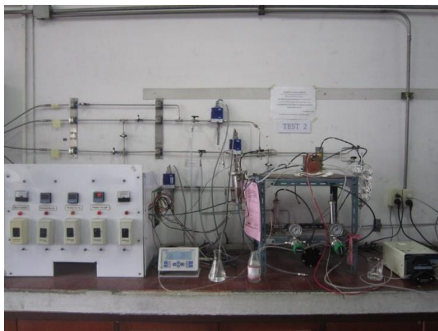
รูปที่ 3. 6 ชุดทดสอบสมรรถนะการทำงานของเซลล์เชื้อเพลิง
