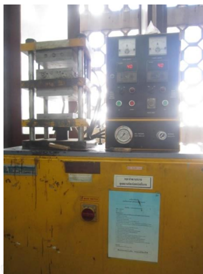
รูปที่ 3. 5 เครื่อง Compression Mold: Lab Tech LP20
