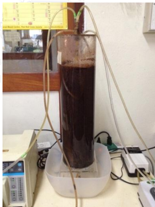
รูปที่ 5.8 ระบบการกรองชีวภาพแบบ Internal loop Airlift Bioreactor ที่บรรจุแบคทีเรียตรึงบนซิลิกา 25 กรัมต่อลิตรและน้ำเสียเจือจาง 4 เท่า จากกระบวนการผลิตของโรงงาน C จังหวัดสุราษฎร์ธานี
