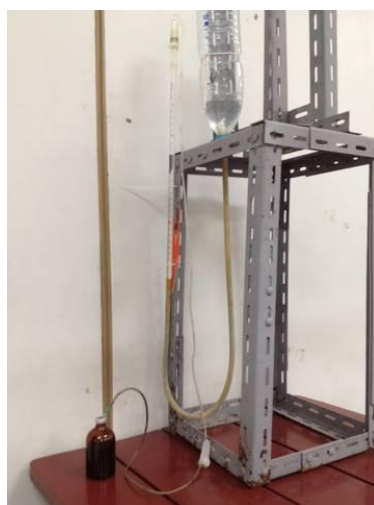
รูปที่ 5.2 การเก็บปริมาณก๊าซชีวภาพด้วยวิธีการแทนที่น้ำ
