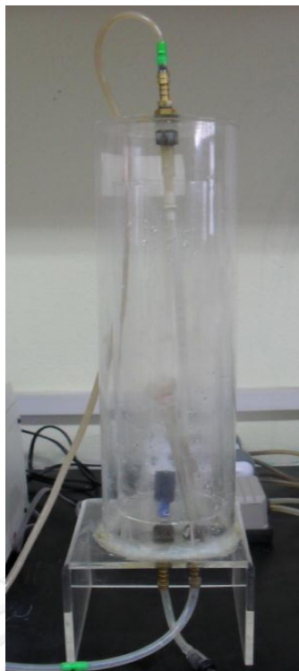
รูปที่ 3.4 ลักษณะของระบบการกรองชีวภาพแบบ Internal loop Airlift Bioreactor ที่สร้างขึ้น
