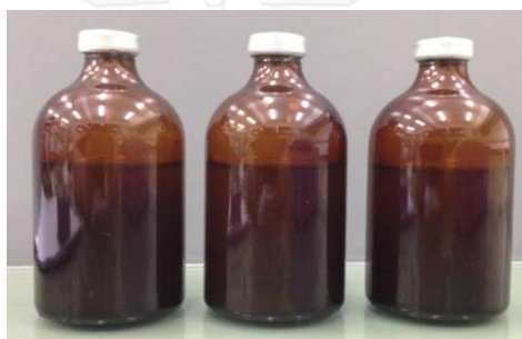
รูปที่ 5.1 ลักษณะระบบผลิตก๊าซชีวภาพแบบขวดซีรัมประกอบด้วย น้ำเสีย ตะกอนจุลินทรีย์แอนแอโรบิกและโซเดียมไบคาร์บอเนต ที่มีการใส่ก๊าซออกซิเจนออกจนหมดและปิดขวดจนสนิท
