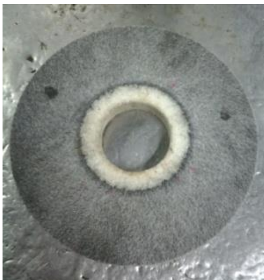
รูปที่ 3. 2 หินเจียรระไนชนิดอะลูมิเนียมออกไซด์
