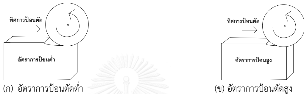
รูปที่ 4.5 รูปแสดงความสัมพันธ์ระหว่างความขรุขระผิวชิ้นงานและอัตราการป้อนตัด
