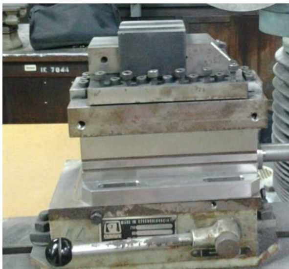
รูปที่ 3. 4 เซนเซอร์วัดแรงหรือไดนามอมิเตอร์
