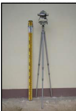
ภาพที่ 3.13 เครื่องมือ Instrument siteline builders level tools สำหรับวัดความลาดชันของพื้นที่
