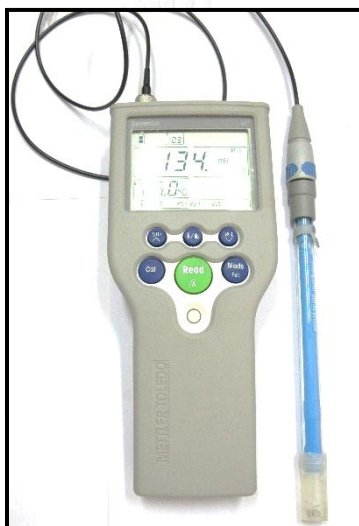
ภาพที่ 3.15 เครื่องมือสำหรับวัดค่า Oxidation-Reduction potential (ORP) ในดิน (รุ่น SG2 – SevenGo™ ของบริษัท Mettler Toledo)
