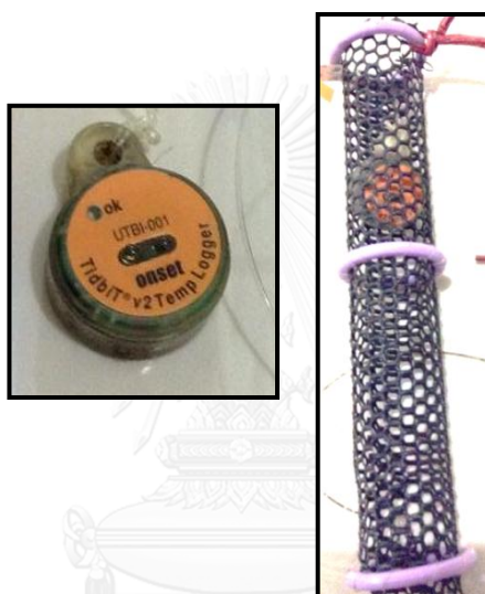
ภาพที่ 3.12 Temperature sensors และ Data loggers สำหรับบันทึกอุณหภูมิดิน น้ำ และอากาศ
