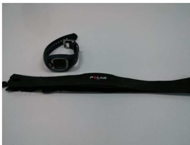
รูปที่ 11 ชุดวัดอัตราการเต้นของหัวใจแบบไร้สาย
