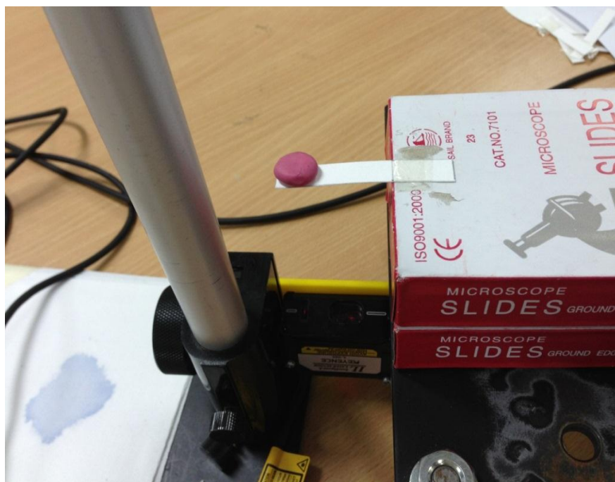
รูปที่ 5.13 การหาค่ามอดูลัสของกระดาศด้วยวิธีการถ่วงมวลดินน้ำมัน
