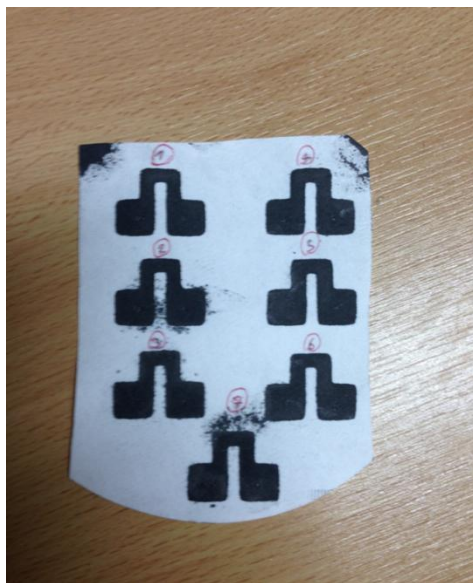
รูปที่ 3.28 วงจรที่พิมพ์น้ำ 5 ครั้ง
