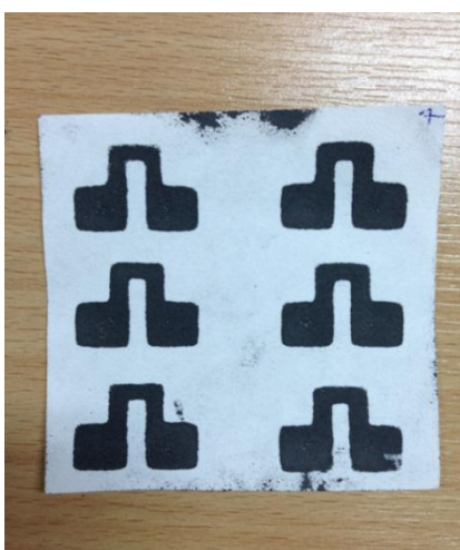
รูปที่ 3.27 วงจรที่พิมพ์น้ำ 4 ครั้ง
