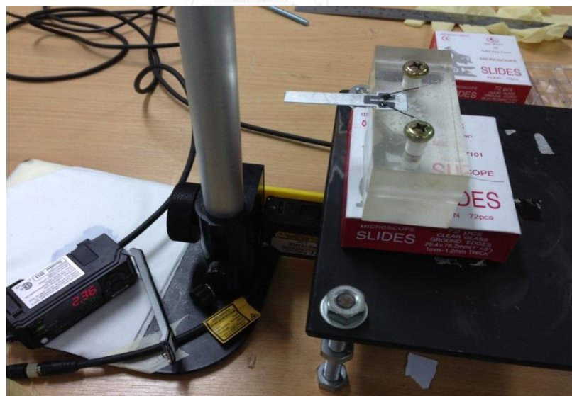
รูปที่ 5.17 การวัดค่าความต้านทานที่เปลี่ยนไปเมื่อมีแรงมากกระทำที่ปลายคาน
