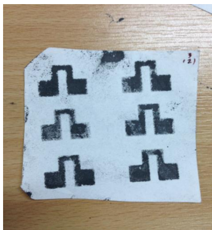
รูปที่ 3.26 วงจรที่พิมพ์น้ำ 3 ครั้ง
