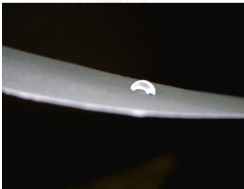
รูปที่ 3.18 ลักษณะหยดน้ำบนกระดาษที่จุ่มในสาร Polystyrene ในสารละลาย Toluene ที่ความเข้มข้น 3% (m/v)
