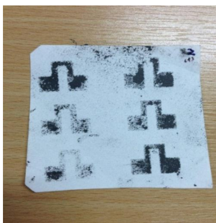
รูปที่ 3.25 วงจรที่พิมพ์น้ำ 2 ครั้ง
