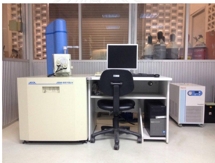
รูปที่ 3.1 เครื่องวิเคราะห์สัณฐานวิทยา SEM
