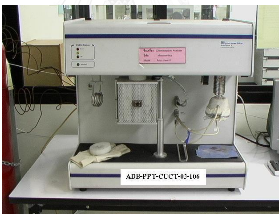
รูปที่ 3.9 เครื่องวิเคราะห์ตำแหน่งว่างไวกรดบนตัวเร่งปฏิกิริยา
