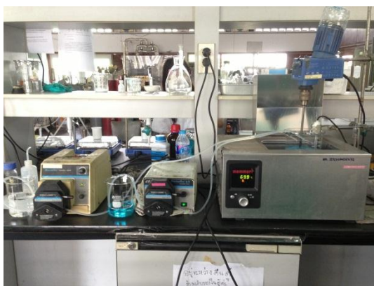
รูปที่ 3.17 เครื่องมือสำหรับการสังเคราะห์ตัวเร่งปฏิกิริยาด้วยการตกตะกอนร่วม
