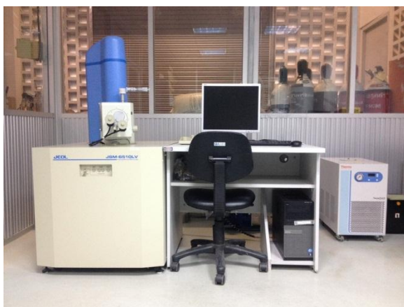
รูปที่ 3.9 กล้องจุลทรรศน์อิเล็กตรอนแบบส่องกราด (SEM)
