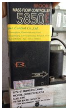
รูปที่ 3.7 เครื่องควบคุมอัตราการไหลเชิงมวล
