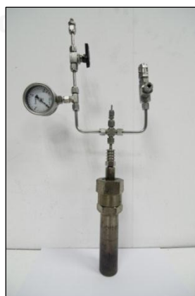
ภาพที่ 3.1 เครื่องปฏิกรณ์ขนาดเล็กขนาด 70 มิลลิลิตร
