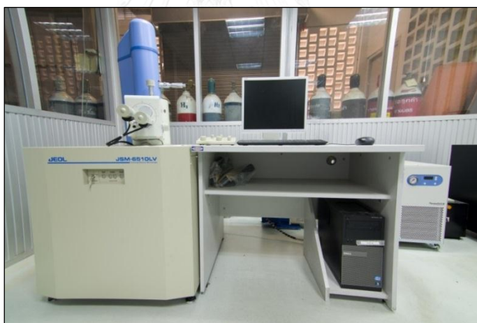
ภาพที่ 3.7 เครื่องสแกนนิ่งอิเล็กตรอนไมโครสโคป
