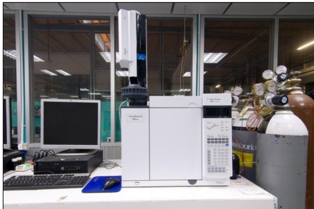
ภาพที่ 3.8 เครื่องแก๊สโครมาโทกราฟีพร้อมซอฟต์แวร์จำลองการกลั่น
