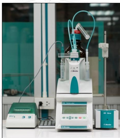
ภาพที่ 3.11 เครื่องมือสำหรับวัดค่าความเป็นกรดของน้ำมัน
