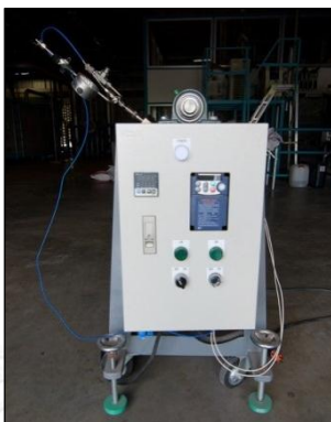
ภาพที่ 3.2 ชุดทดลอง อุปกรณ์ควบคุมอุณหภูมิแบบดิจิทัล หม้อแปลงไฟฟ้าและเครื่องเขย่า
