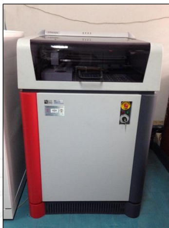
ภาพที่ 3.4 เครื่องเอกซเรย์ฟลูออเรสเซนซ์สเปกโตรมิเตอร์
