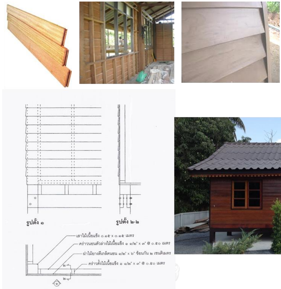
ภาพที่ 3.2 แสดงการติดตั้งผนังไม้ฝาตีซ้อนเกล็ดทางนอน 1/2"x6" (Wood)
