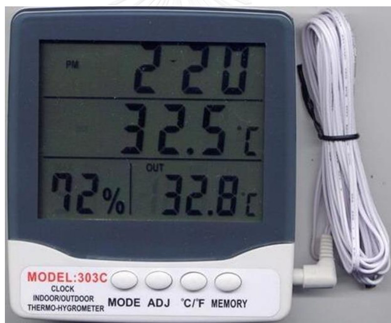
ภาพที่ 3.13 แสดงเครื่องวัดอุณหภูมิและความชื้นสัมพัทธ์ รุ่น DIGICON Model: 303C
