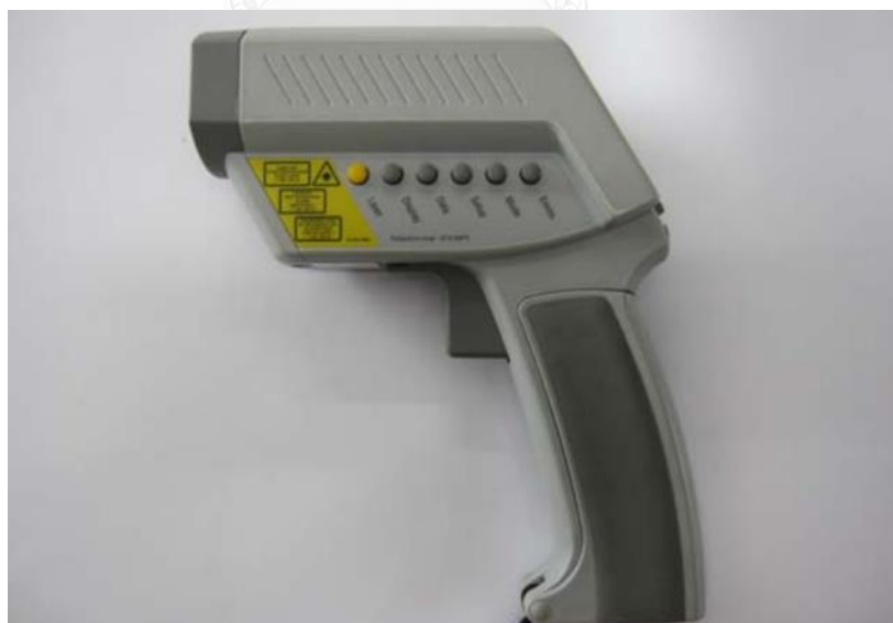
ภาพที่ 3.12 แสดงเครื่องมือวัดอุณหภูมิผิววัสดุด้วยรังสีอินฟราเรด รุ่น testo 860-T2
