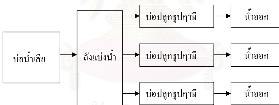
รูปที่ 3.1 ผังการไหลของน้ำเสียและแปลงทดลองที่ใช้ในงานวิจัย
