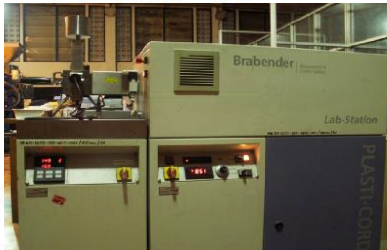
รูปที่ 3.2 เครื่องบดผสมแบบภายใน (internal mixer) ยี่ห้อ BRABENDER รุ่น W30 EHT
