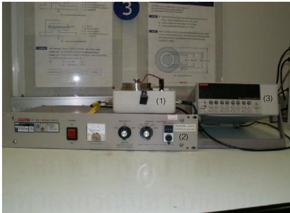
รูปที่ 3.11 เครื่องทดสอบสภาพต้านทานไฟฟ้าเชิงปริมาตร โดยจะใช้เครื่อง Resistivity Adapter รุ่น Keithley 6105 (1) ร่วมกับเครื่อง High Voltage Supply รุ่น Keithley 247 (2) และ เครื่อง Electrometer รุ่น Keithley 617 (3)
