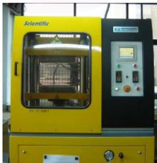
รูปที่ 3.4 เครื่องอัดแบบ (compression molding) รุ่น LAB TECH
