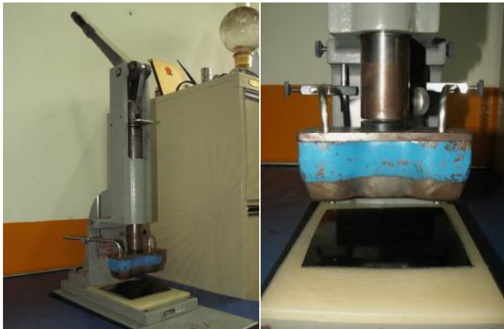
รูปที่ 3.8 เครื่องตัดชิ้น specimen ยี่ห้อ Wallace test equipment
