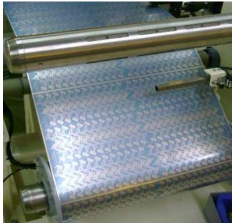
ภาพที่ 1.8 กระบวนการล้างฟิล์มไวแสง
